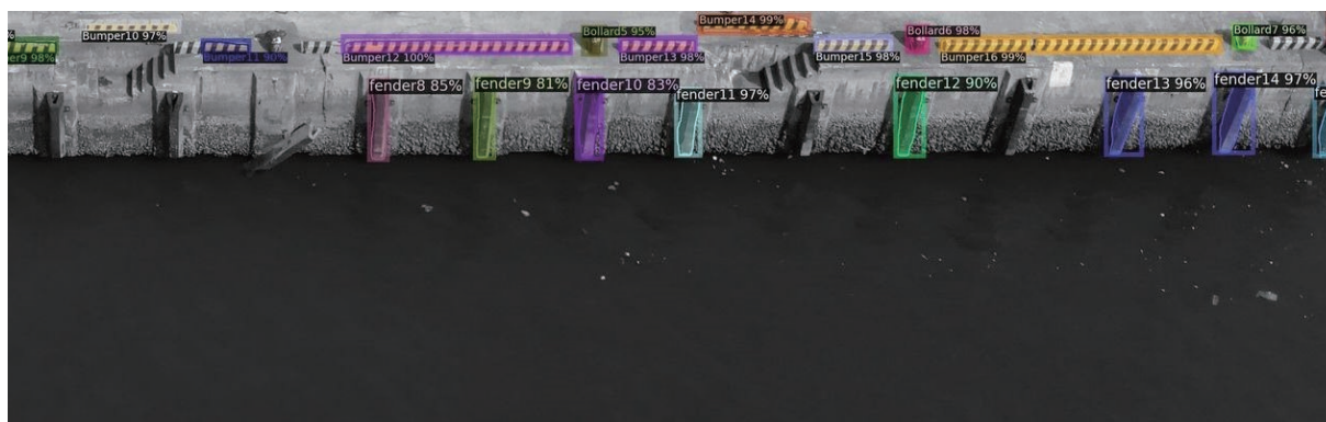
臺北港岸邊設施（碰墊、反光板及車擋）多物件辨識模組應用測試
