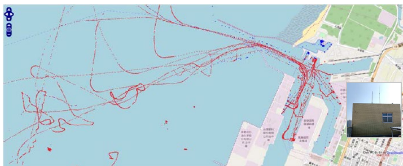
圖 5.2 運研所臺中港 AIS 船舶軌跡示意圖
