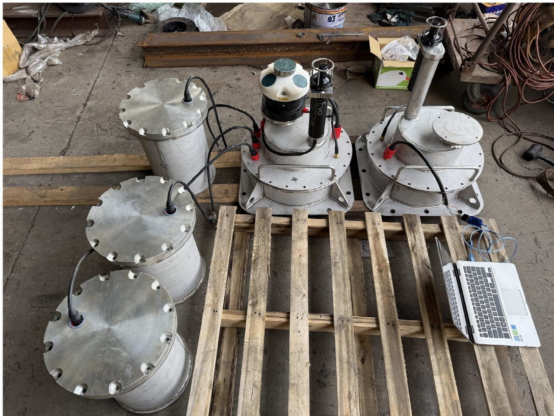
(b) 離、近岸電控箱體及電池模組
