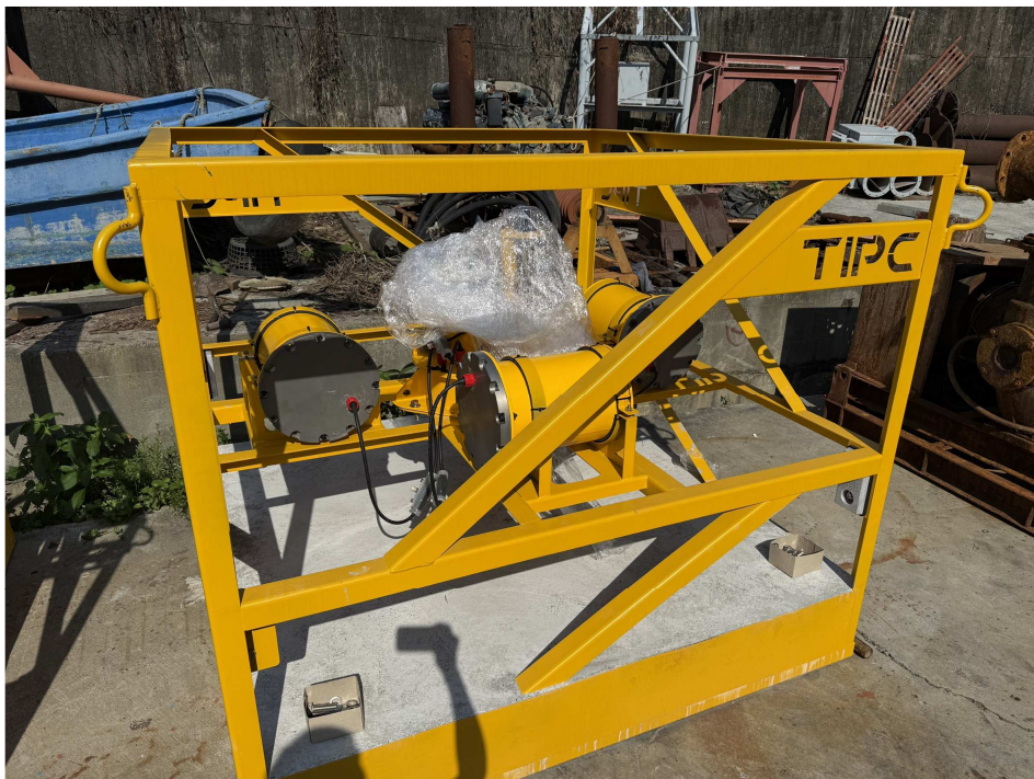
(b) 離岸端（含不銹鋼水密箱、電控箱、水聲數據機、AWAC、電池組）
