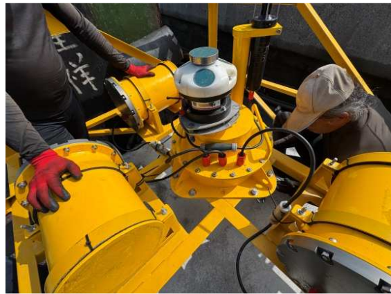
(b) 離岸端儀器架設置
