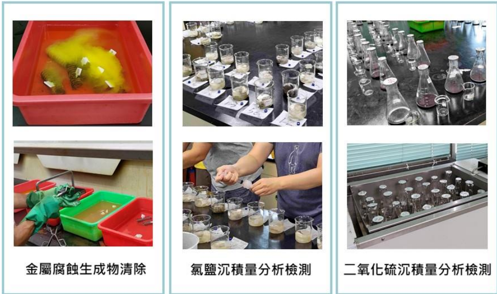
大氣腐蝕試驗取樣後處理作業 (每年1,4,7,10月辦理)
