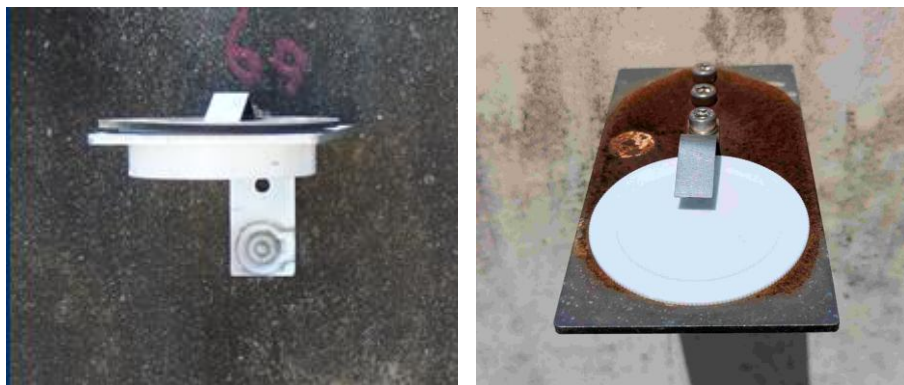
圖 3.7 二氧化硫沉積量採集裝置
