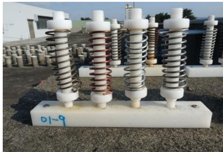
圖 3.9 螺旋狀試片暴露試驗
