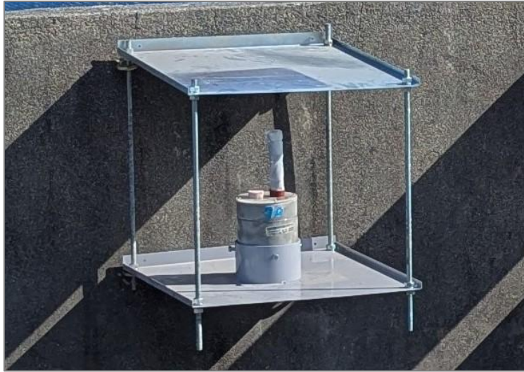
圖 3.4 氯鹽沉積量採集裝置
