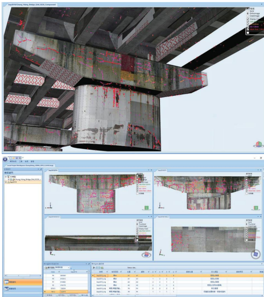
圖 5.1 本所橋梁劣化 AI 影像辨識系統裂縫偵測成果
