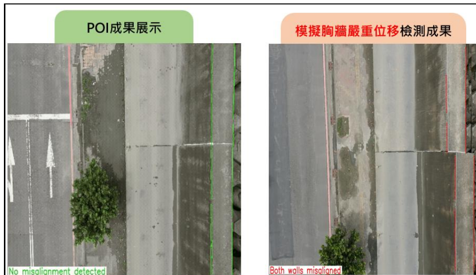
圖 6.65 113 年 10 月胸牆法線錯位成果與模擬錯位成果檢測
