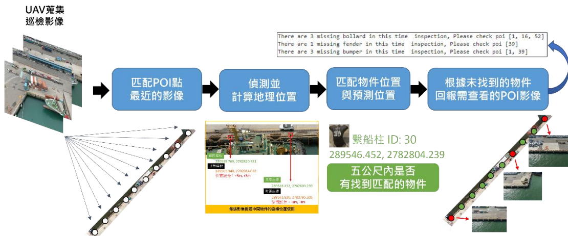
圖 6.9 岸邊設施的地理定位與巡檢邏輯流程圖
