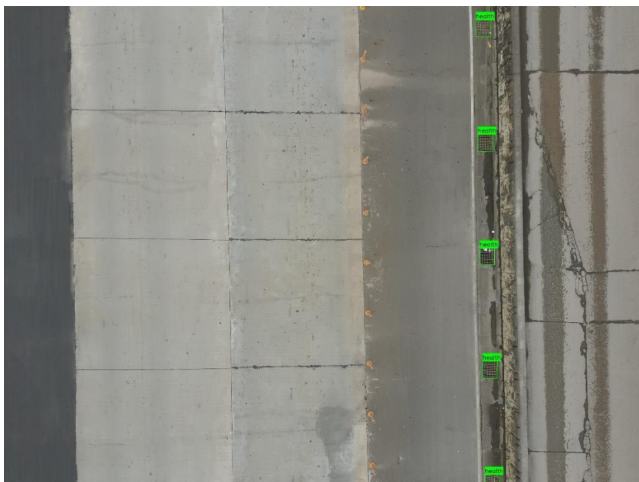
圖 6.87 排水溝蓋堵塞檢測成果展示圖
