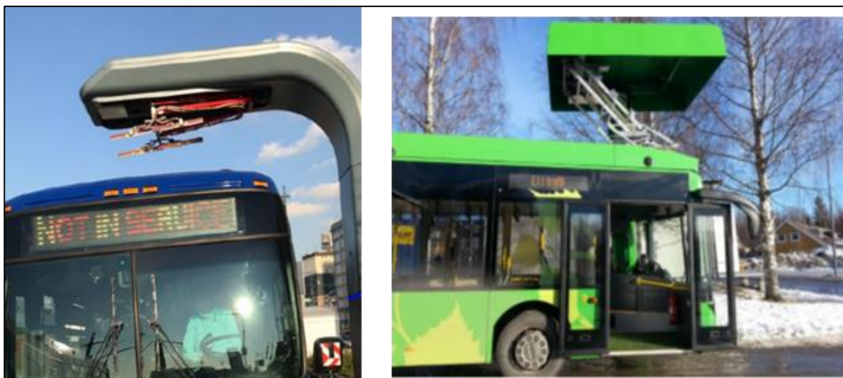
圖 2.1.1 SAE J3105/1 電動大客車自動充電系統圖
