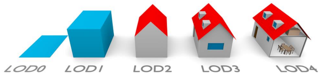
圖 4.2.2-4 CityGML 建物模型細緻度等級（LOD）示意圖
