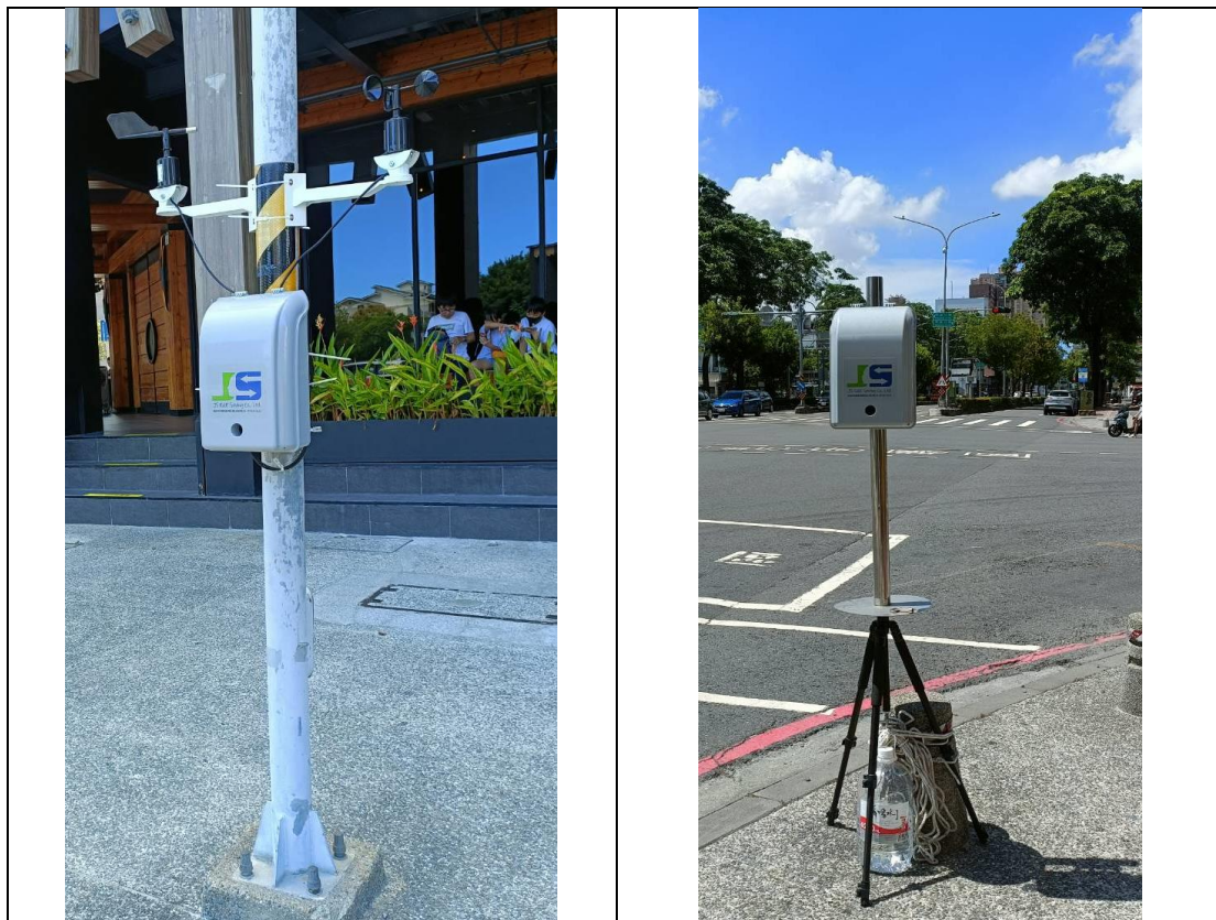
圖 2.2.3-2 行人等候區之定點式空污監測儀器示意圖
