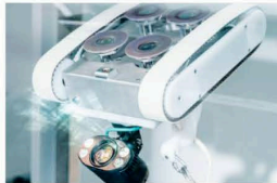
(b)真空吸盤+履帶型無人地面載具，應用於平整的客機表面檢測
