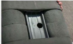
(a)真空腔+高密度泡棉履帶無人地面載具，應用於平整水壩之水泥表面檢測
