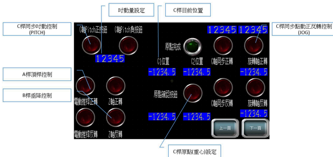
PLC人機操作畫面(一)_量測操作
