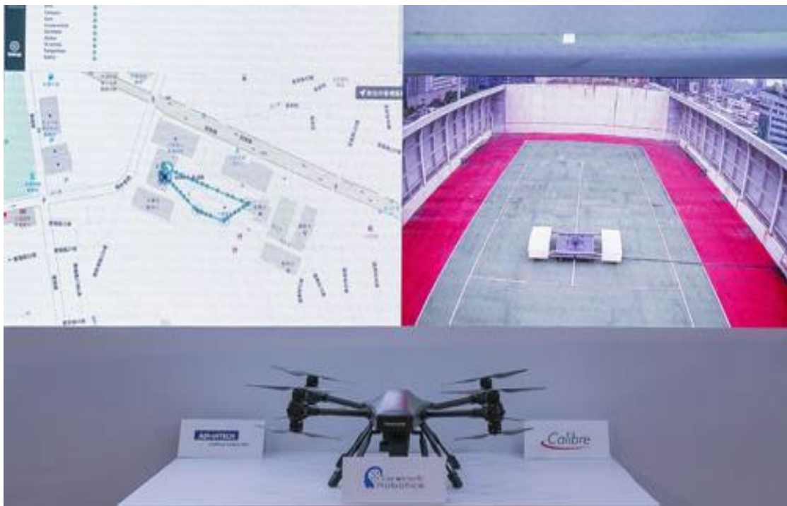
圖 3.35 5G 遠距遙控無人機空中監控巡檢
