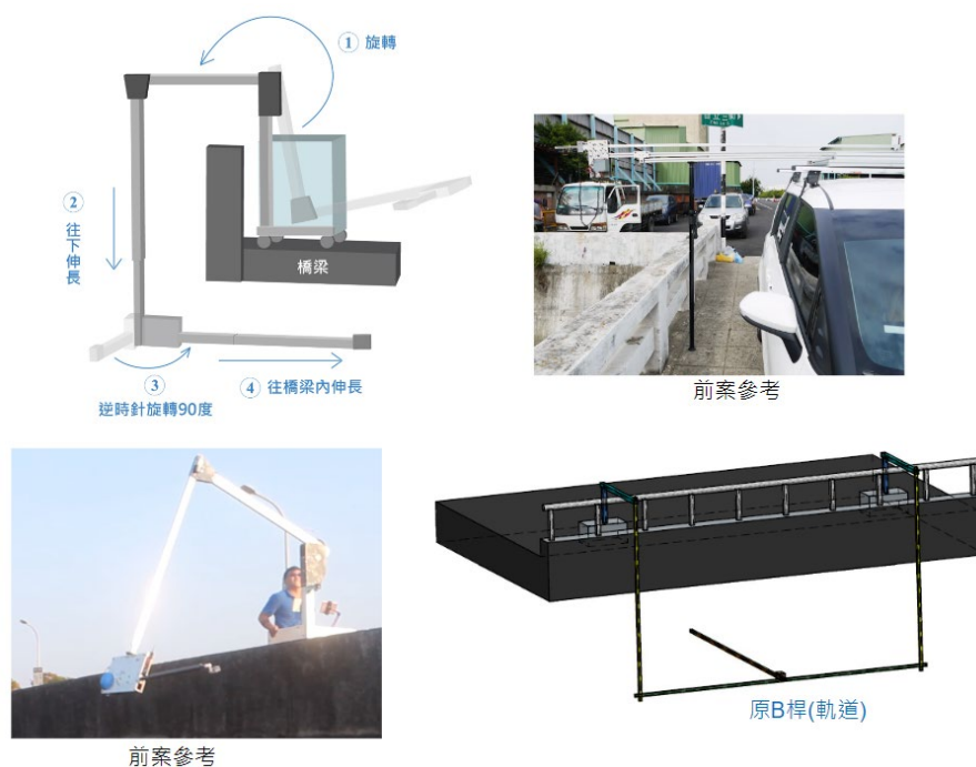
圖 3.22 參考前案設計將軌道移往橋面(已設計變更)
