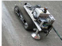
(a)真空腔+高密度泡棉履帶無人地面載具，應用於平整水壩之水泥表面檢測
