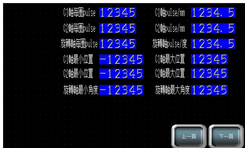
圖 3.63 PLC 人機操作畫面(三)_電機參數設定
