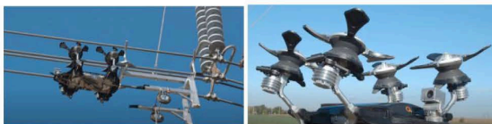
(e)鋼索攀附型無人地面載具沿著高壓電塔電線之間穿梭
