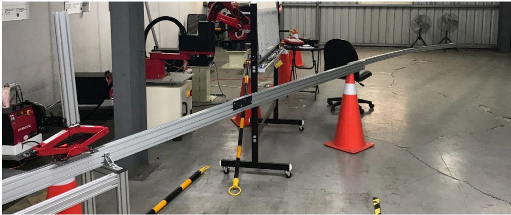
圖 3.2 長懸臂(10 公尺)變形量實測圖
