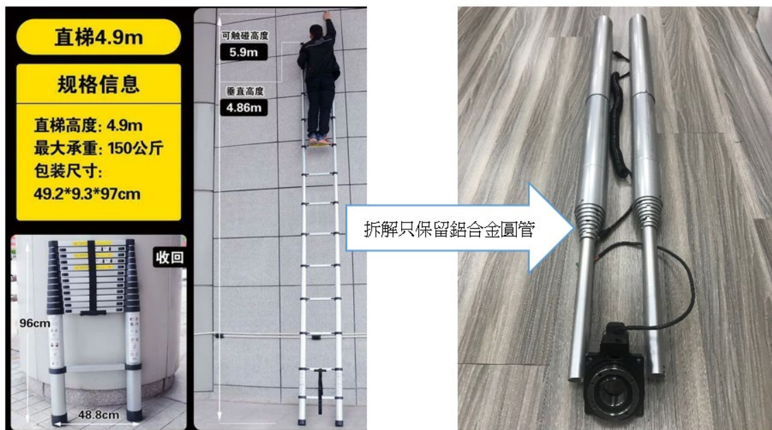
圖 3.55 B 桿原型採用工程用伸縮一字梯
