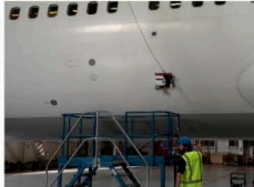
(b)真空吸盤+履帶型無人地面載具，應用於平整的客機表面檢測
