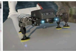
(c)真空吸盤+多足型無人地面載具，應用於風力發電葉片爬行維修與檢測
