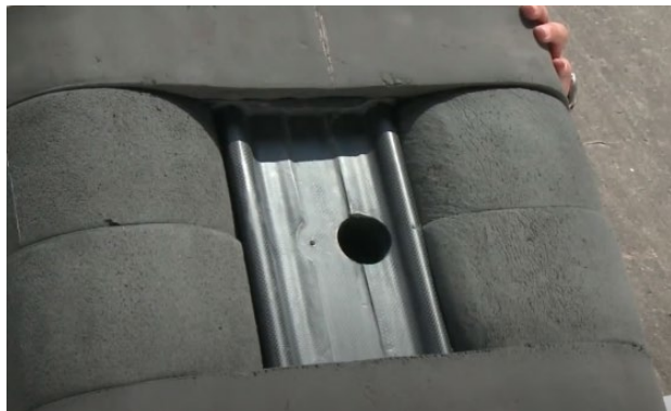
(a)真空腔+高密度泡棉履帶載具，應用於平整水壩之水泥表面檢測
