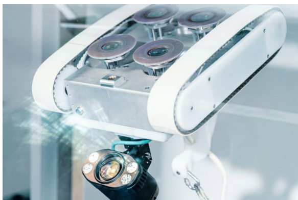
(a)真空腔+高密度泡棉履帶載具，應用於平整水壩之水泥表面檢測
