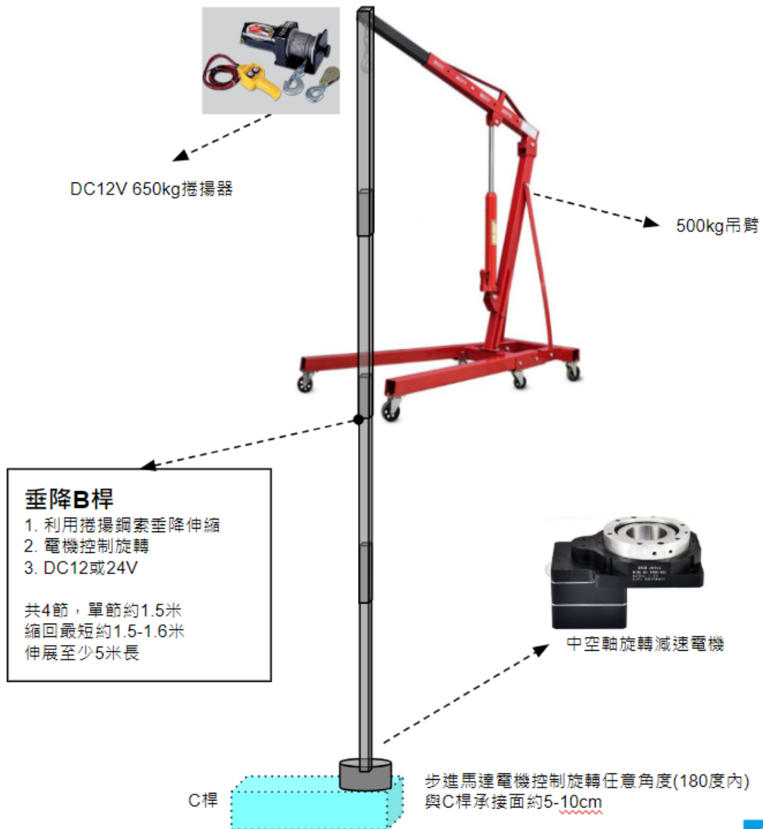
圖 3.25 立柱 ABC 桿系統架構圖(測試用雛形機)
