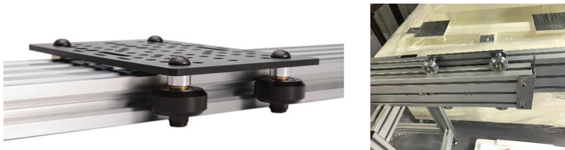
圖 3.5 模組化 C 桿滑輪組設計圖
