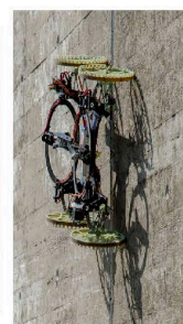
旋翼壓附式無人地面載具，應用於各種材質及曲面之牆體
