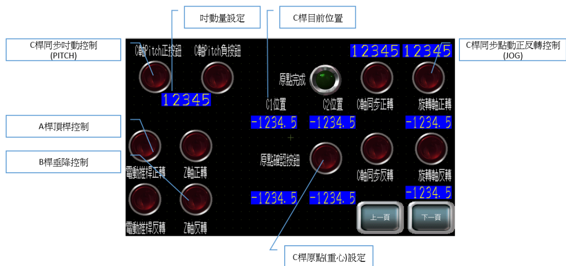
圖 3.61 PLC 人機操作畫面(一)_量測操作
