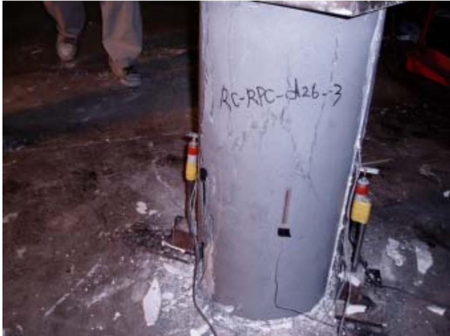
圖 6.60 RPC 補強組試體破壞外觀(2)
