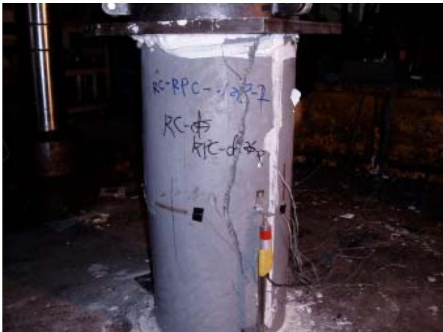
圖 6.59 RPC 補強組試體破壞外觀(1)
