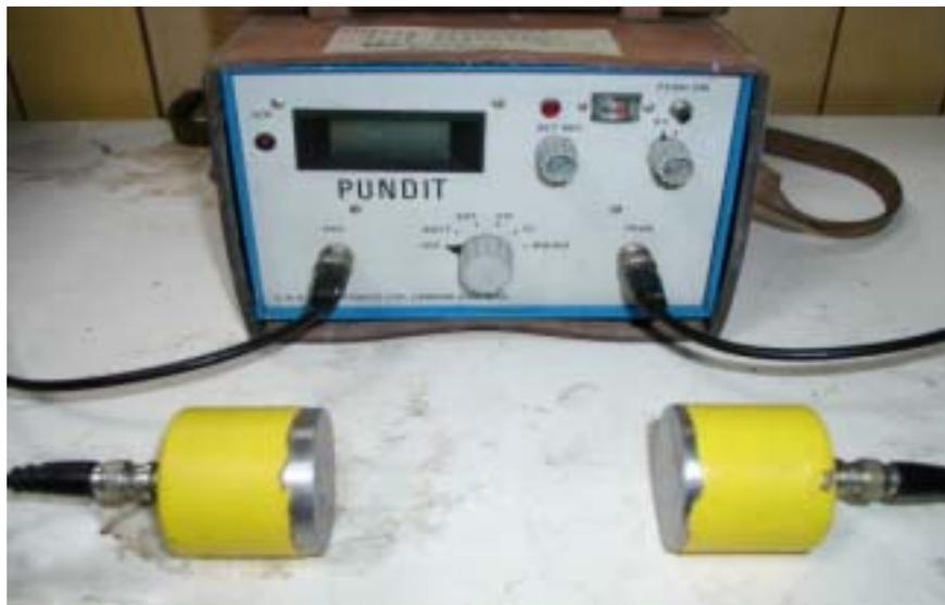
照片 4.2 超音波試驗儀
