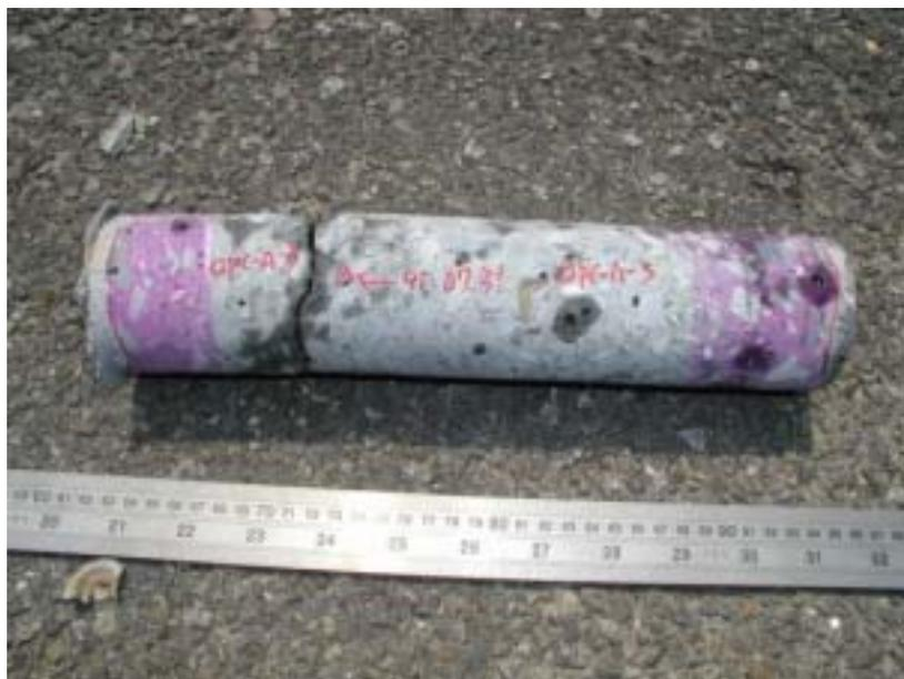
照片 4.9 95 年量測中性化較為嚴重的 OPC 混凝土試體
