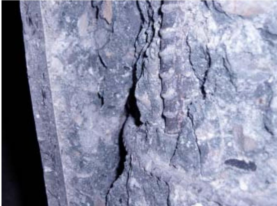
圖 6.61 RPC 補強組試體破壞後界面黏結情形
