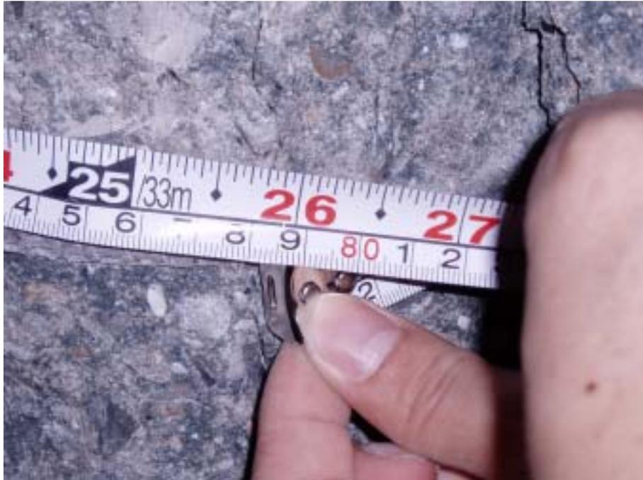
圖 6.42 控制組試體箍筋長度量測
