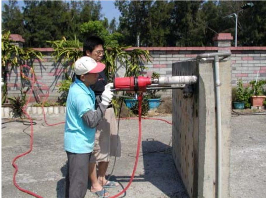
照片 4.1 混凝土試驗牆鑽心試驗
