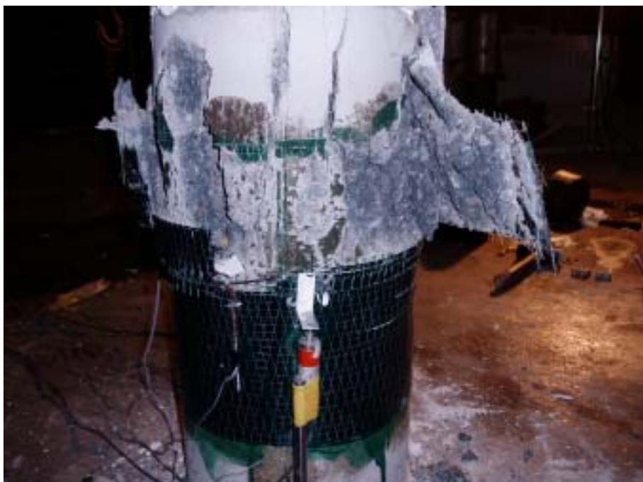
圖 6.51 CFRP 補強組試體破壞外觀(2)
