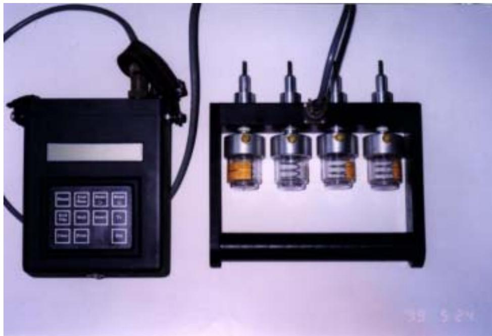
照片 4.3 混凝土電阻係數量測儀
