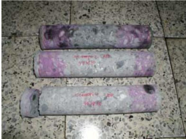
照片 4.8 94 年量測中性化較為嚴重的 OPC 混凝土試體
