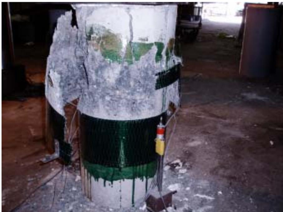
圖 6.50 CFRP 補強組試體破壞外觀(1)
