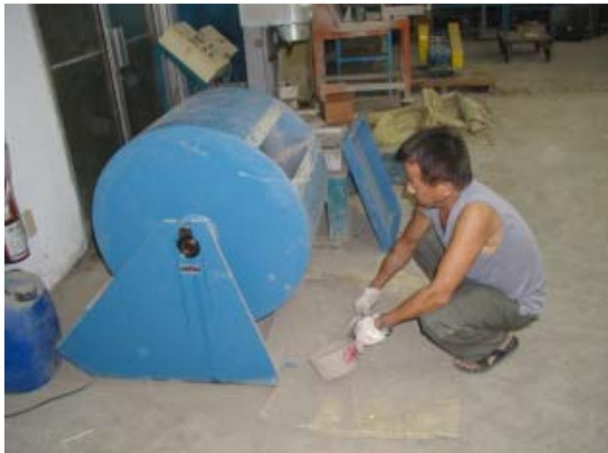
照片 4.11 洛杉磯磨損試驗儀
