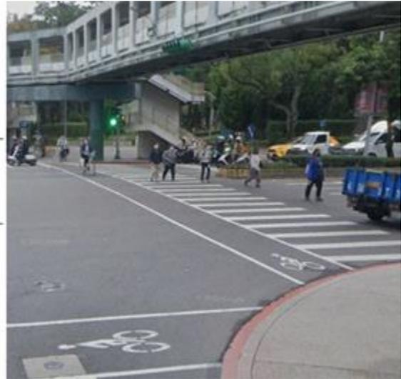
圖 11-2 自行車穿越道與行穿線合併（密接式）
