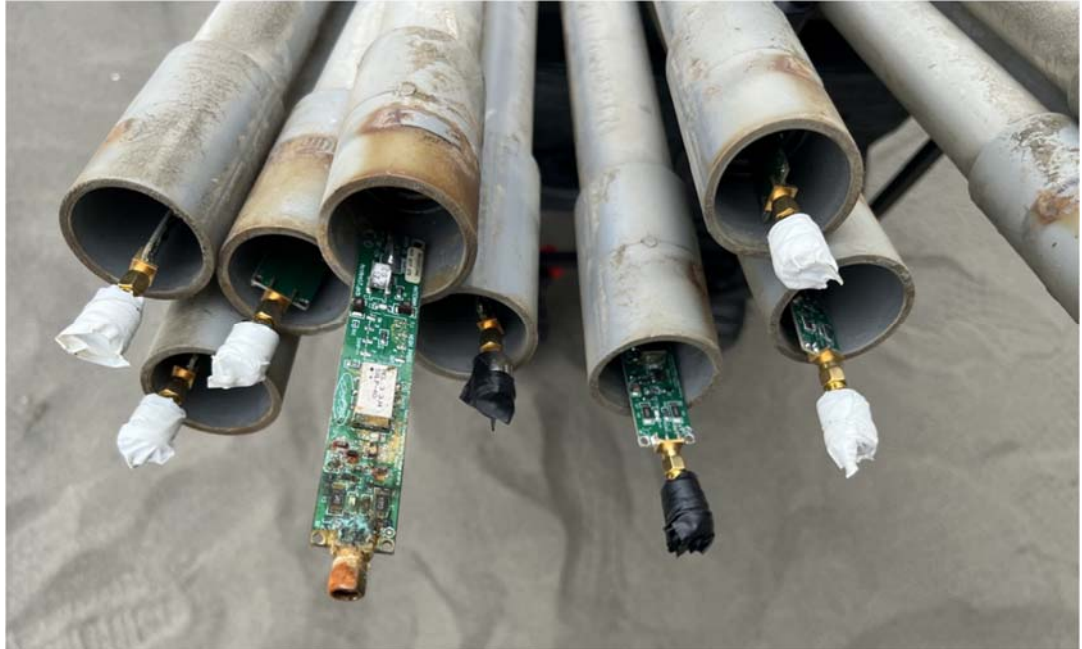
圖 3.15 主動式天線低通濾波器銹蝕情形
