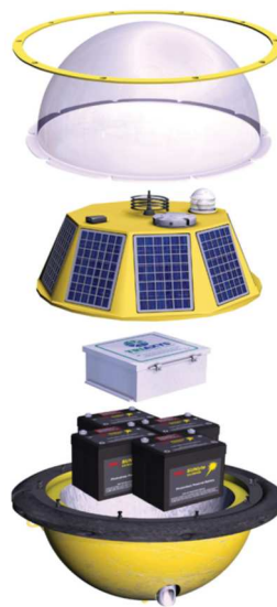
圖2.19 資料浮標組成示意圖
