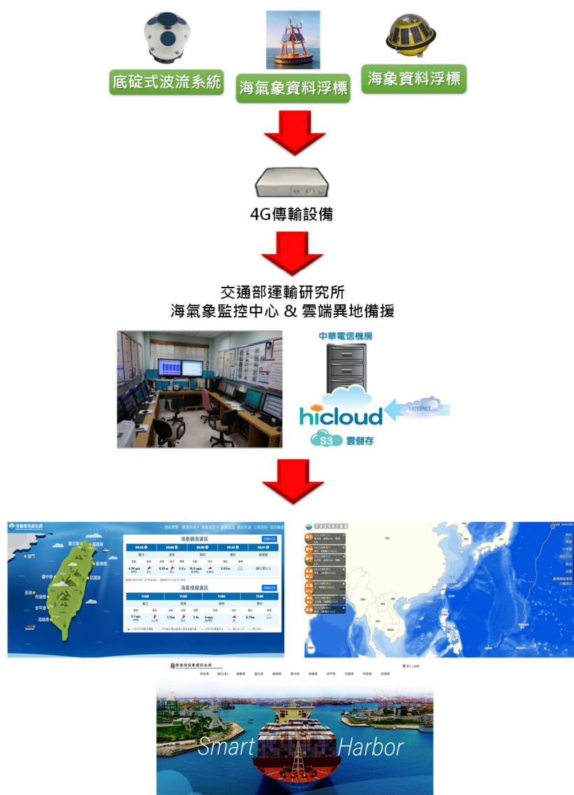
圖 2.1 海象觀測系統傳輸架構圖
