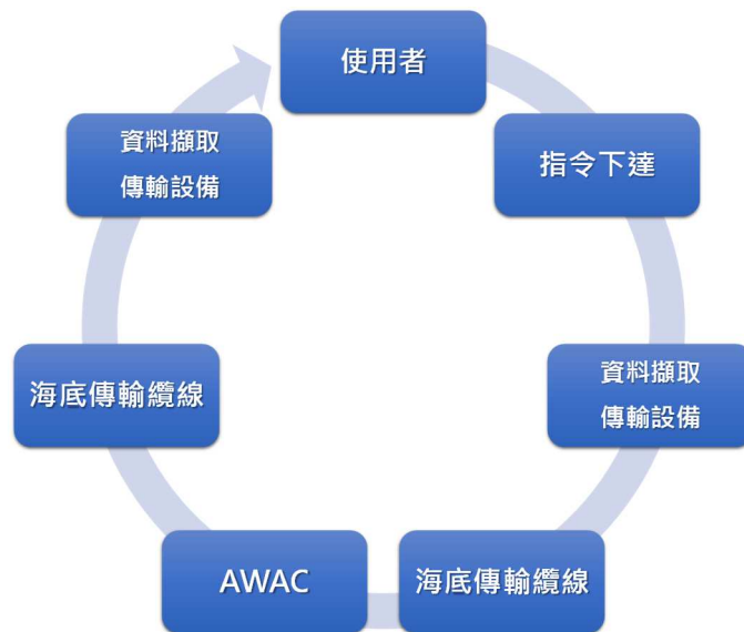
圖4.7 底碇式觀測系統指令暨資料傳輸架構
