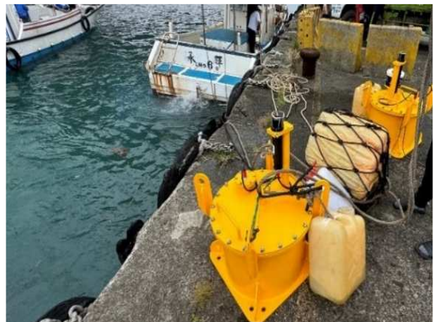
(c) 水下安裝作業(左)、箱體回收拆解分析(右)
