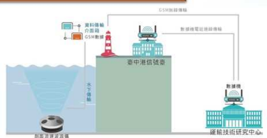
既有底碇式波流觀測系統架構圖
