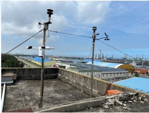
運技中心風速站現場配置圖 (2組超音波式及1組風杯式)
