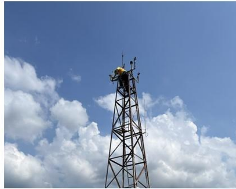
基隆港風速站現場配置圖 (2組超音波式及2組氣象署螺旋槳式)
