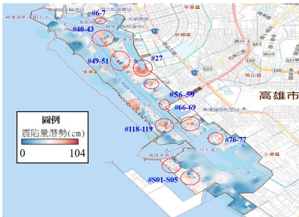
圖 5.4 設計地震下高雄港可能發生震陷位置示意圖
