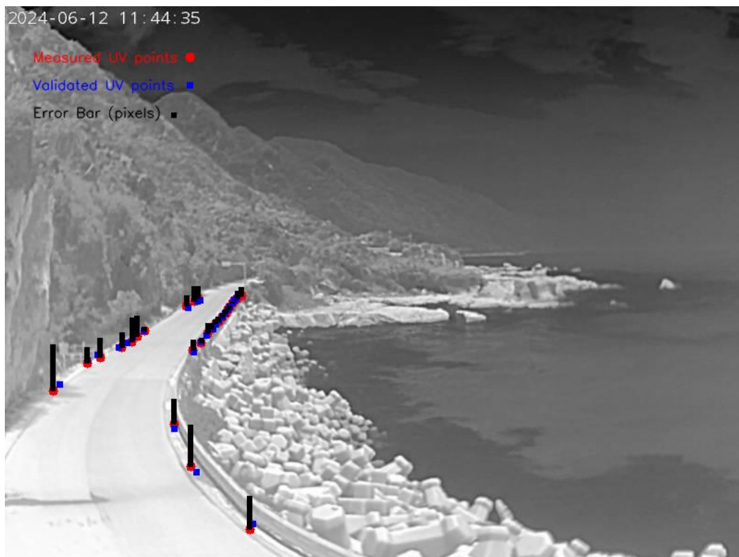
圖 6.15 共線方程計算水平誤差分析 (熱成像)
