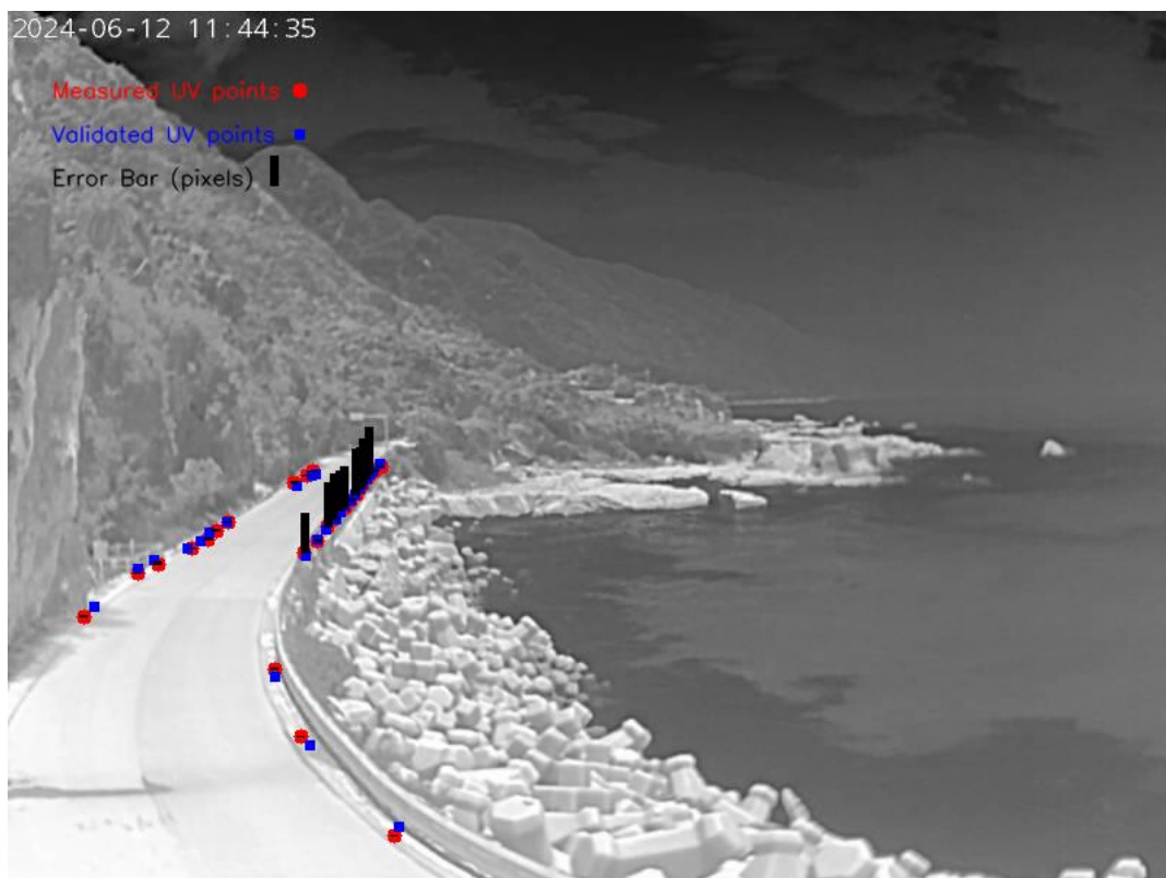
圖 6.16 共線方程計算高程誤差分析 (熱成像)
