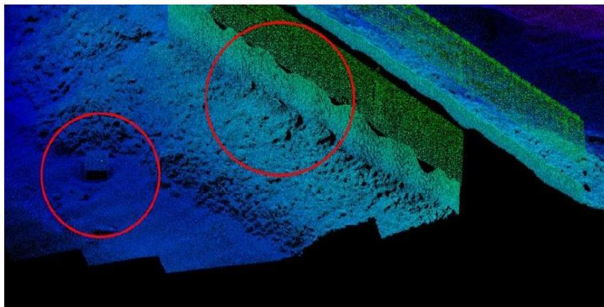
圖 4.11 護基塊護面塊散亂、下陷<sup>[5]</sup>
