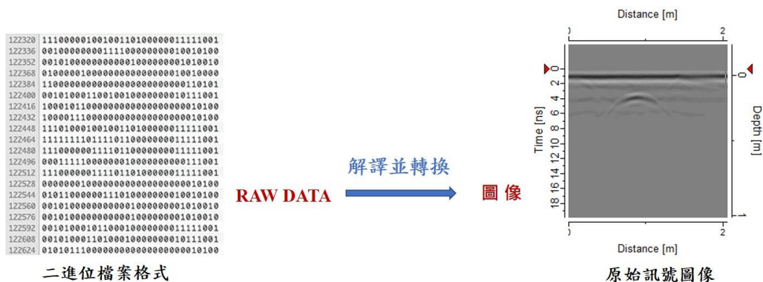
圖 3.3 二進位檔案格式解譯並轉換成圖像之示意圖
