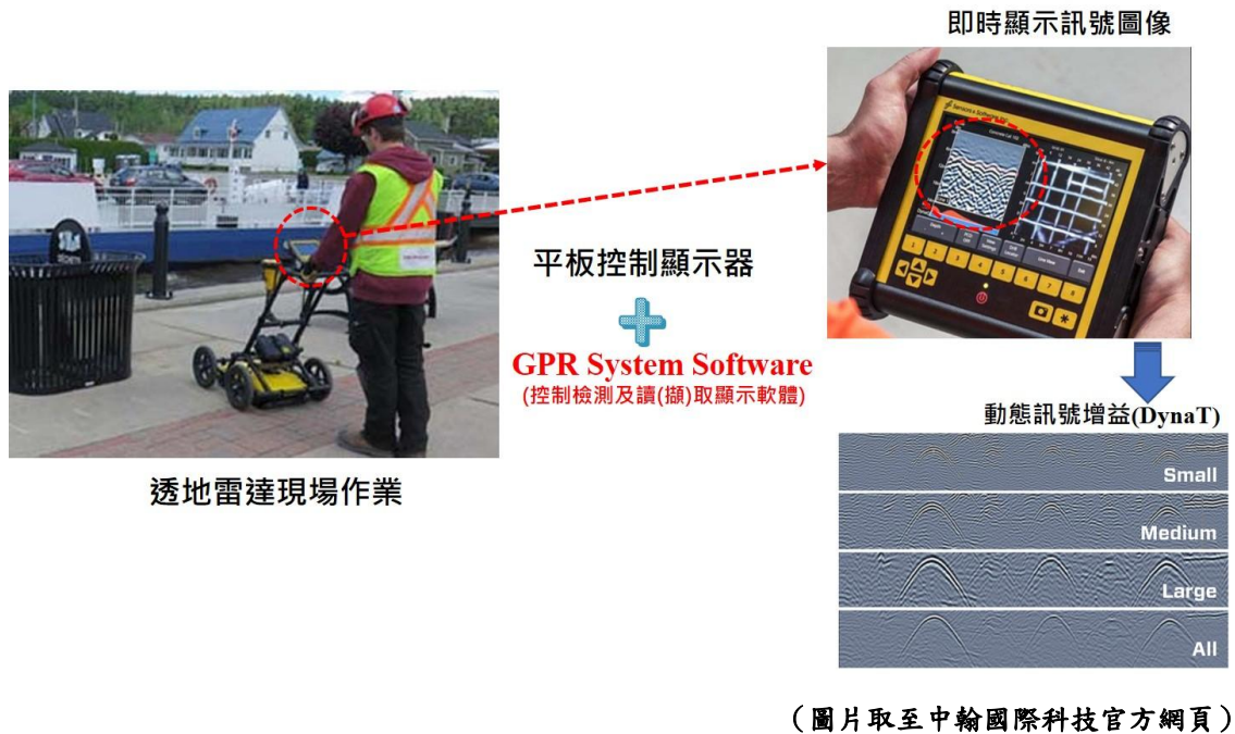
圖 3.4 透地雷達現場作業
