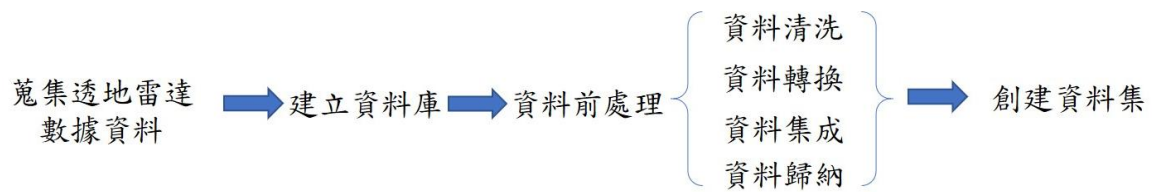
圖 3.6 透地雷達數據前處理程序
