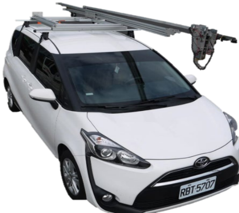
圖 3.1 以廂型車為載具的橋檢設備
