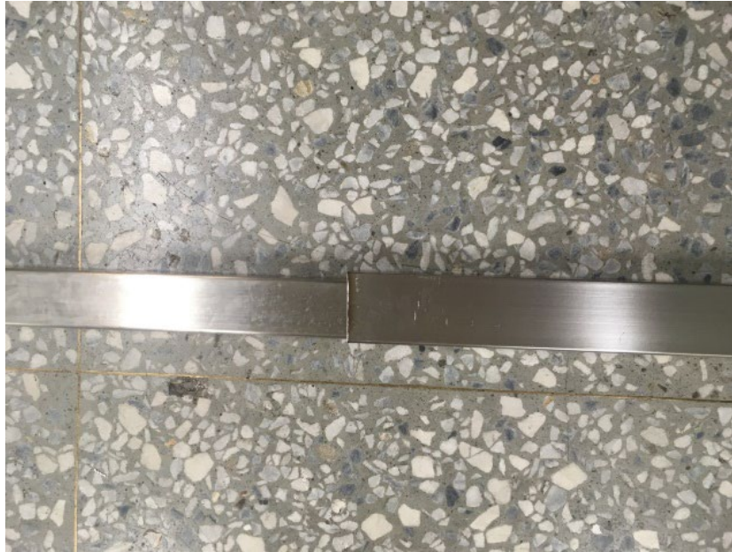
圖 3.9 B 桿伸縮套管設計
