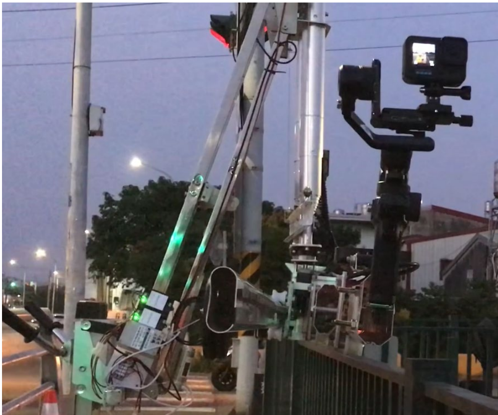
圖 2.9 控制 A 桿舉升跨越護欄
