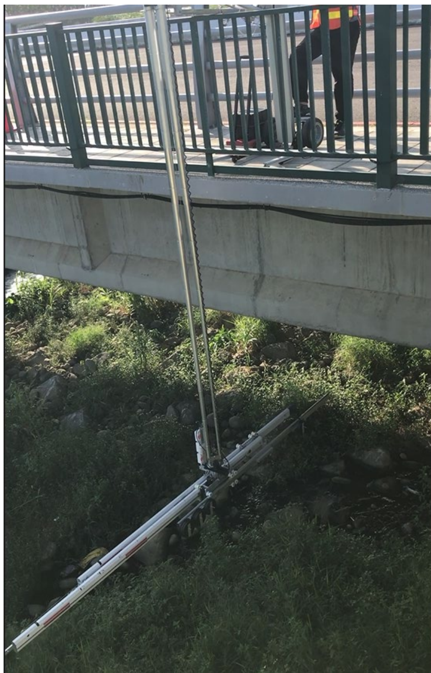
圖 2.11 控制 C 桿旋轉 90 度開始檢測
