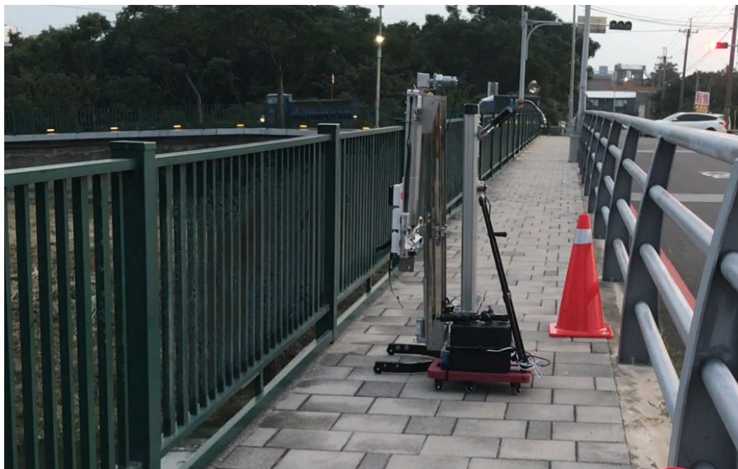
圖 2.7 推車本體推至定位後架設組立
