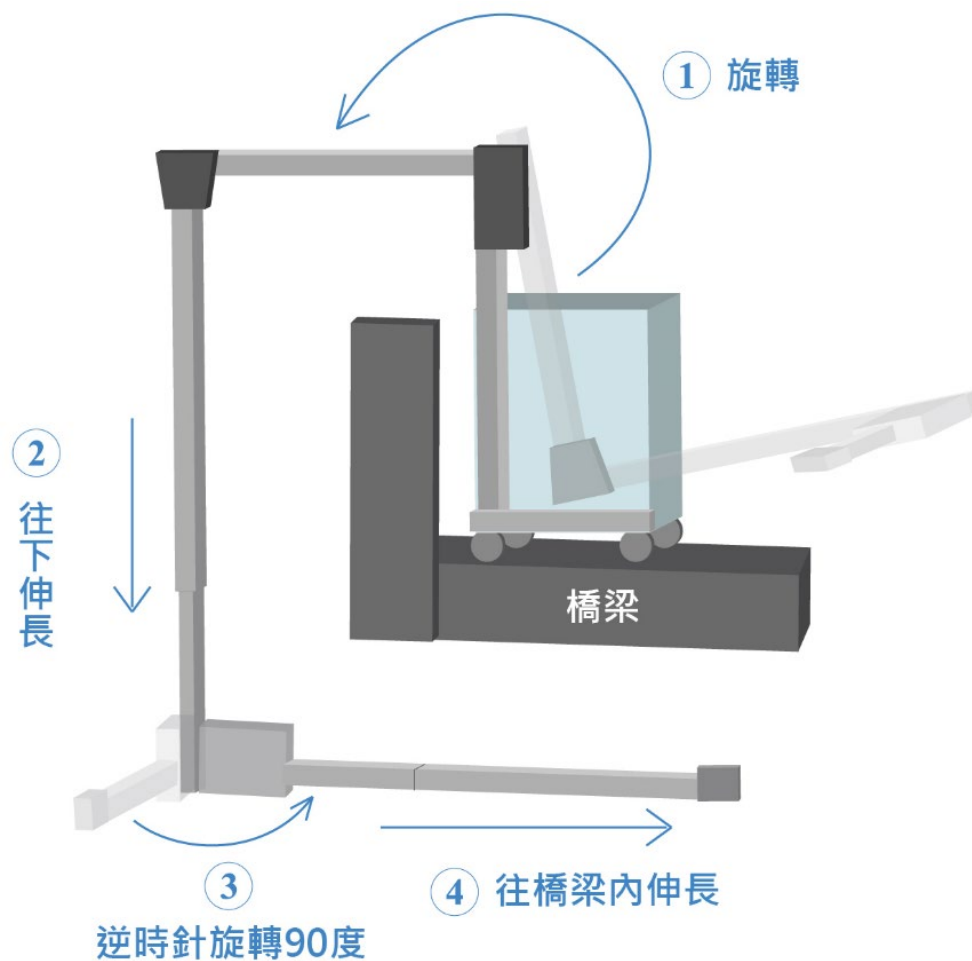
圖 3.3 推車型橋梁檢測設備運作示意圖
