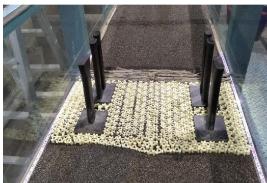
圖 2.28 一層鼎型塊+織布+石籠冲刷情形
