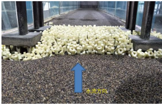
圖 2.20 現況保護措施基礎上游冲刷情形
