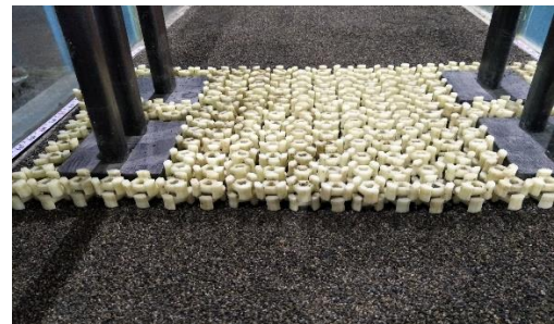
圖 2.17 現況保護措施模型鋪設
