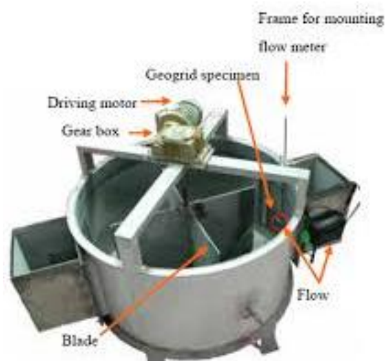
圖 2.6 直徑 1.5 m 高 1.0 m 之圓形流槽
