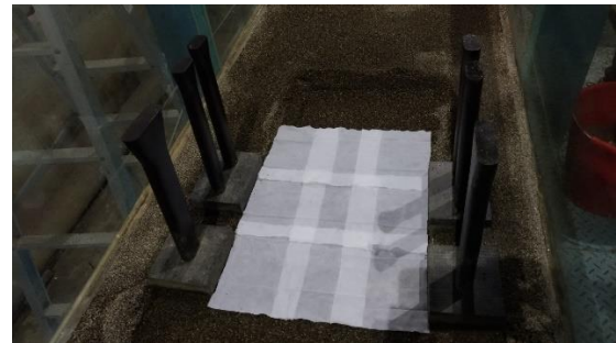
圖 2.23 一層鼎型塊+織布鋪設
