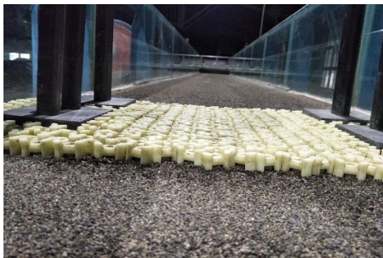
圖 2.24 一層鼎型塊+織布保護措施模型鋪設
