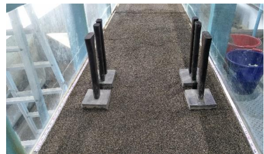
圖 2.19 無保護措施橋墩鋪設
