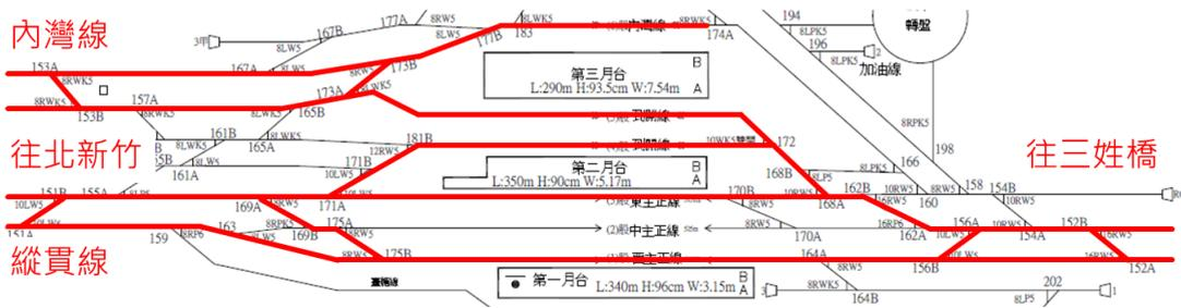
圖 4.2-13 臺鐵新竹站之軌道布置情形
