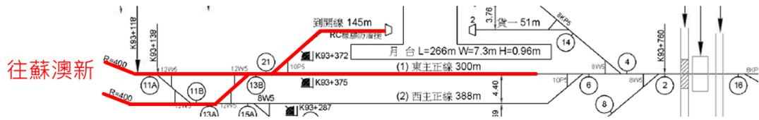
圖 4.2-4 臺鐵蘇澳站之軌道布置情形
