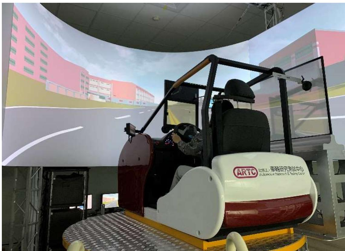
圖 2-33 ARTC 六軸運動平臺駕駛模擬器
