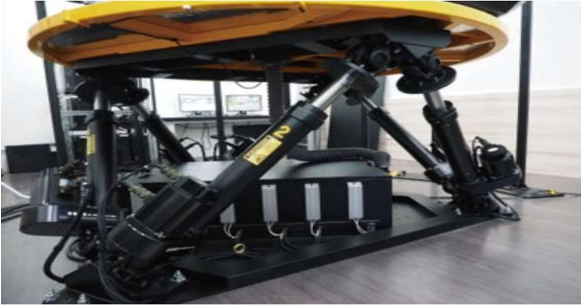
圖 2-34 ARTC 六軸運動平臺駕駛模擬器基座
