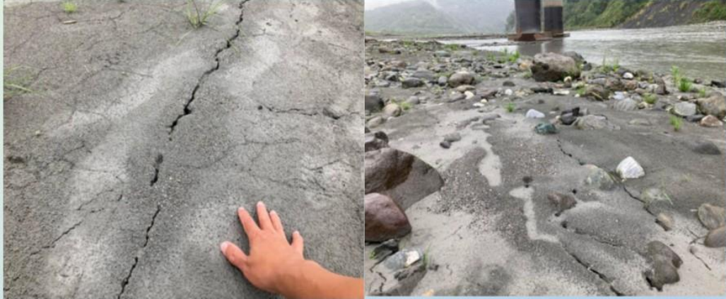
玉里大橋下小規模液化噴砂現象
