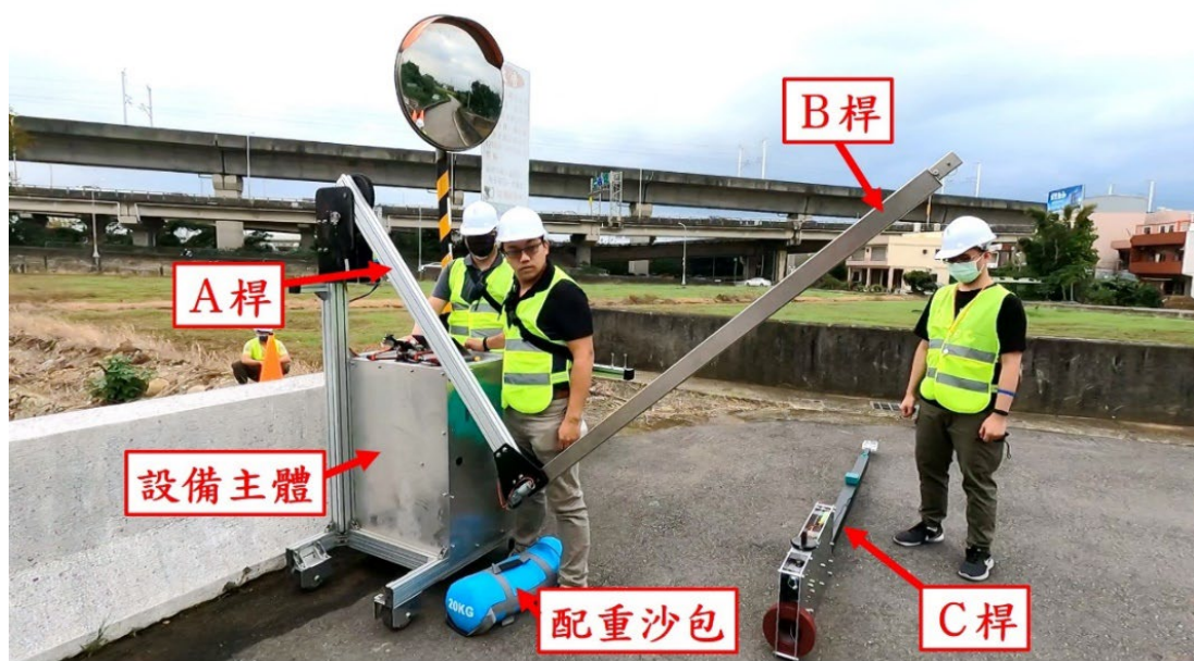
圖 3.42 第二代「推車型橋梁檢測設備」設備整體分解圖
