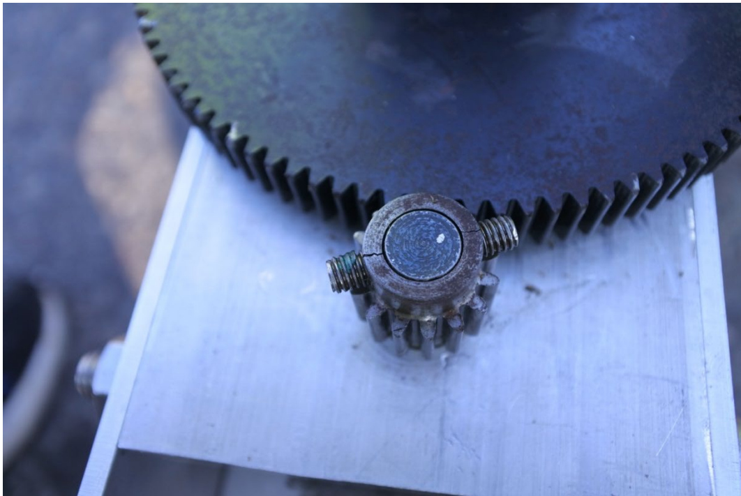
圖 5.23 C 桿轉正齒輪崩裂情形
