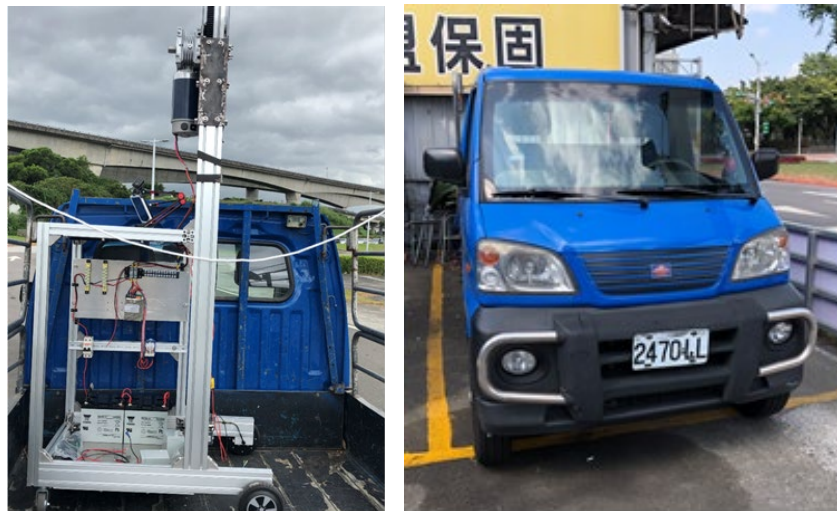
圖 3.29 「推車型橋梁檢測設備」設備搬運照
