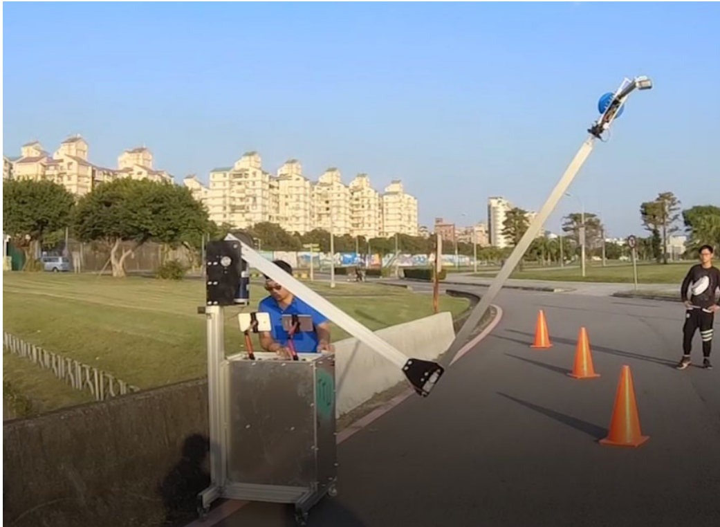
圖 3.37 「推車型橋梁檢測設備」操作(一)
