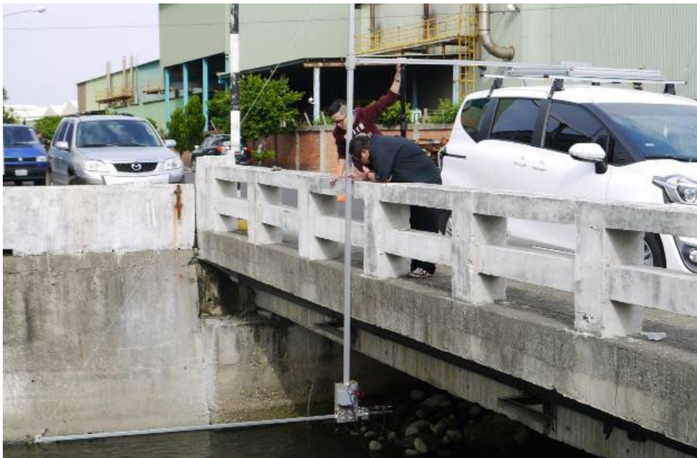
圖 3.28 利用步進馬達將 C 桿送入橋下
