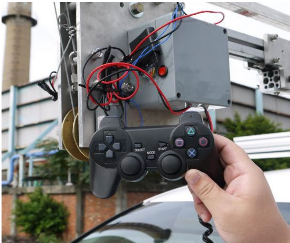
圖 3.17 以遊戲遙桿透過 Arduino 無線模組控制步進馬達
