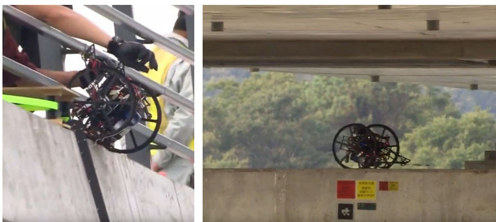
圖 2.44 可於特定橋梁構件中行走之 UAV
