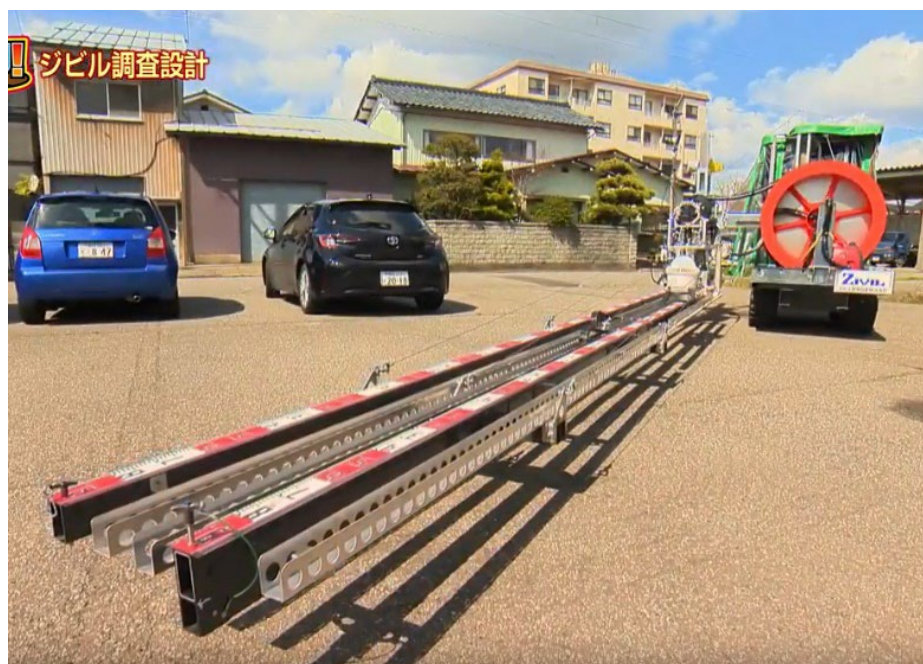
圖 2.19 検測臂組立後情形
