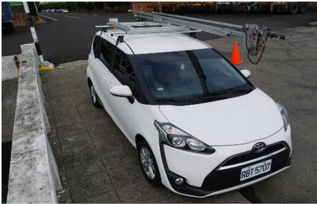
圖 3.24 車載型檢測設備安裝完成情形
