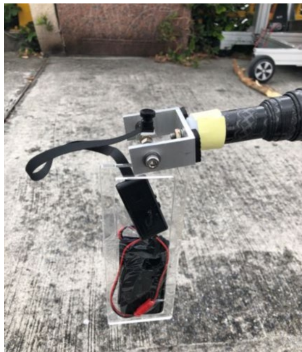
圖 3.20 C 桿尾端攝影鏡頭及自配重裝置
