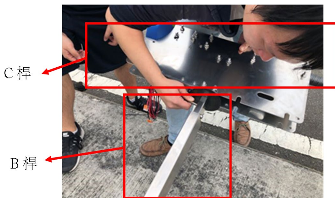
圖 3.32 利用插銷將 C 桿固定於 B 桿末端
