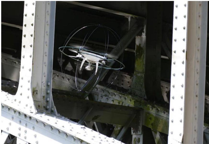
圖 2.39 DJI Phantom 4 用碳纖維防護罩
