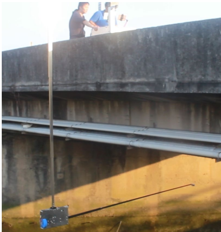
圖 3.39 「推車型橋梁檢測設備」操作(三)
