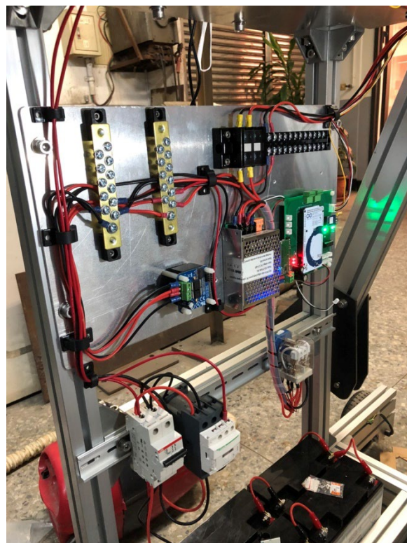
圖 3.6 基座側邊配置控制器與線路
