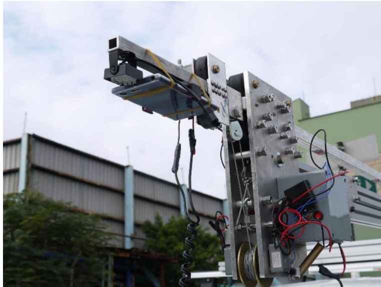
圖 3.19 以智慧型手機進行梁底影像拍攝
