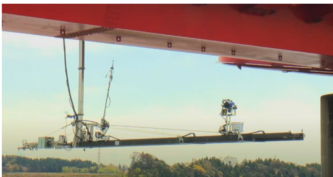
圖 3.46 Zivil 公司機械手臂檢測設備之鋼索設置情形
