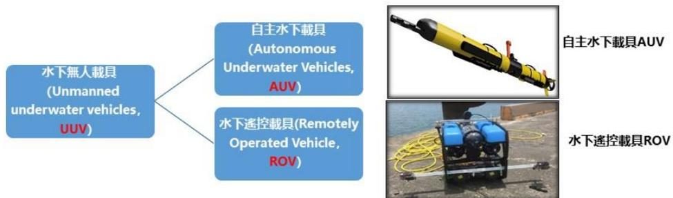
**ROV與AUV**此兩者均為無人水下載具，最大的不同為有無電纜，ROV為經由電纜來遙控操縱的機體，AUV則不具電纜而是以自主航行與自主控制來運作的機體。
