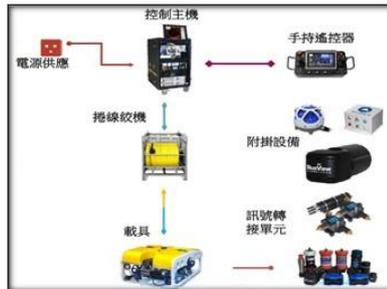
常見ROV系統，包括電源供應、控制主機、手持遙控器、捲線絞機、附掛設備、訊號轉接單元、載具。
