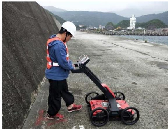
圖 4.26 透地雷達檢測工作情形<sup>[12]</sup>
