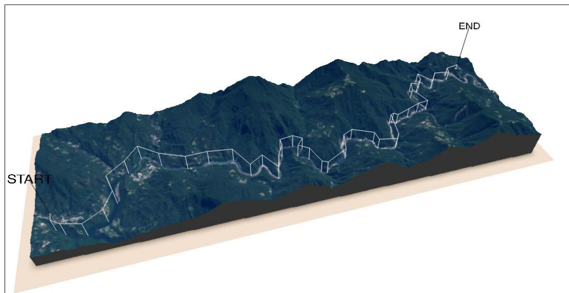
圖 39 模擬海拔 900 公尺固定高度航線圖
