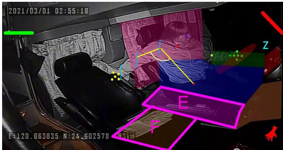
圖 5.1-15 駕駛伸手拿東西「手伸至後方取物」判斷作法示意
