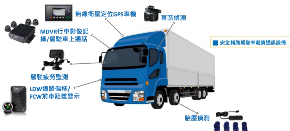
圖 2.6-7 銓鼎科技車載硬體設備示意圖
