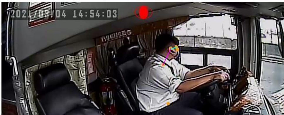
圖 5.1-1 駕駛頭部擺左之關節點推論作法示意
