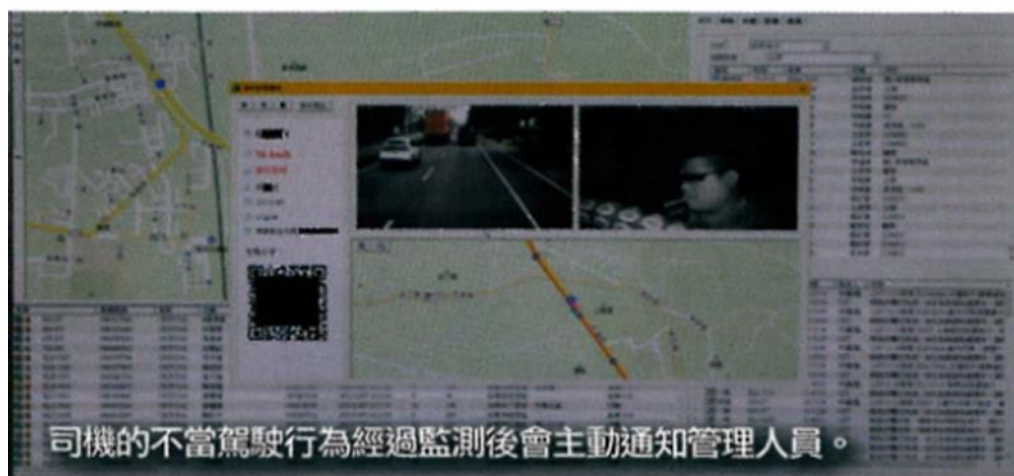
圖 2.6-9 長輝資訊科技公司監控平台疲勞分心監控畫面
