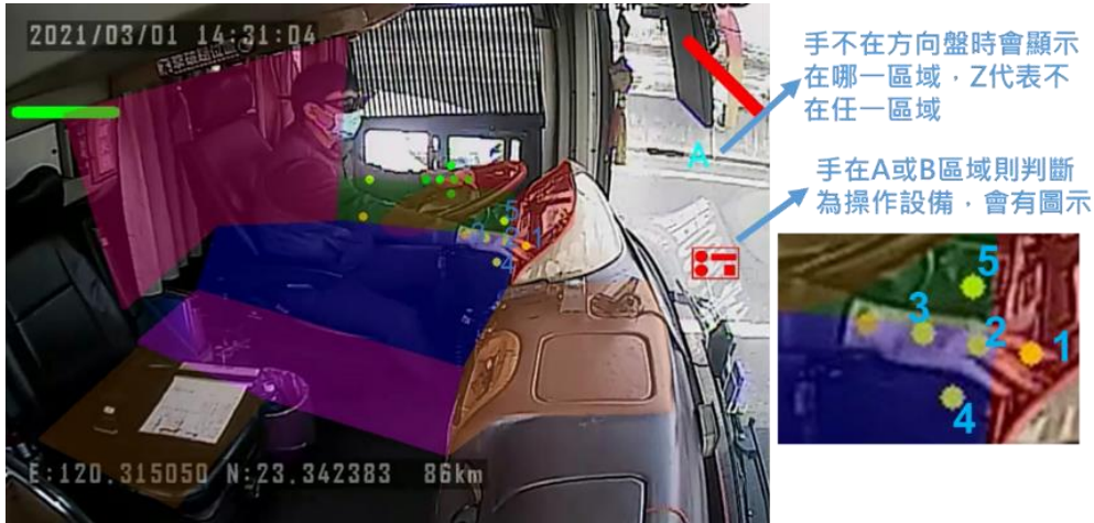
圖 5.1-8 駕駛手部位置操作車內設備示意
