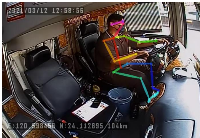
圖 5.2-1 駕駛關節點辨識結果圖形化表示
