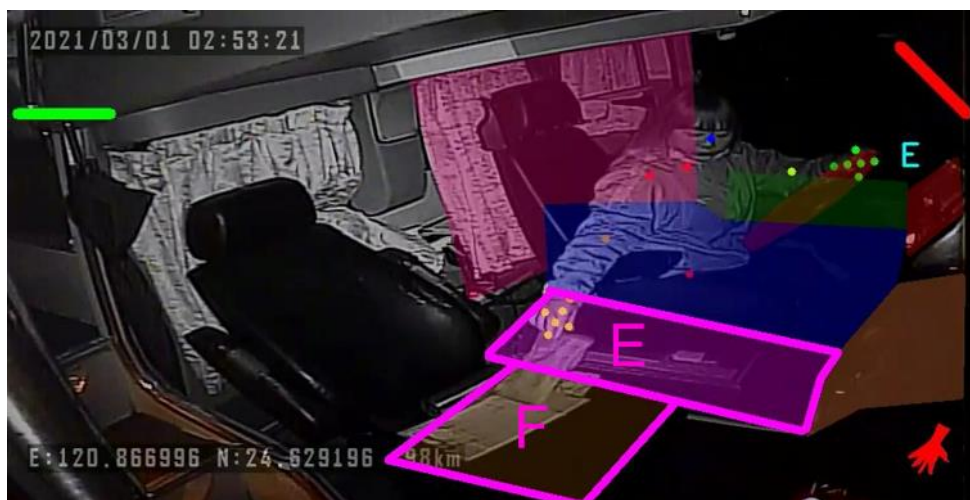
圖 5.1-14 駕駛伸手拿東西「手在區域 E 或區域 F」判斷作法示意
