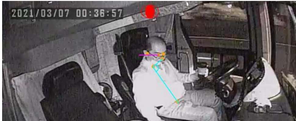
圖 5.1-13 駕駛低頭動作之關節點推論作法示意
