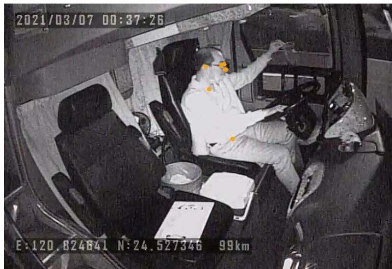
圖 5.1-9 駕駛頭部動作之關節點推論作法示意
