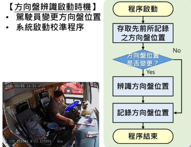
圖 5.1-4 方向盤辨識機制程序啟動示意
