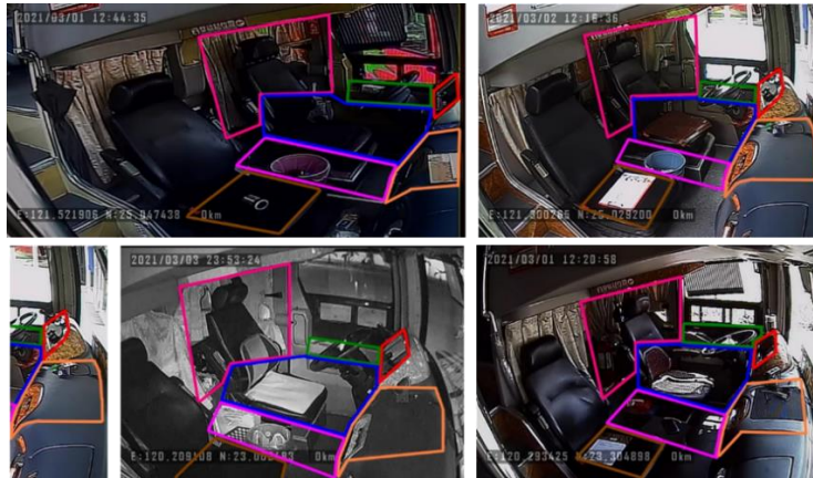
圖 5.1-6 各車輛駕駛座艙內人工手繪 ROI 示意
