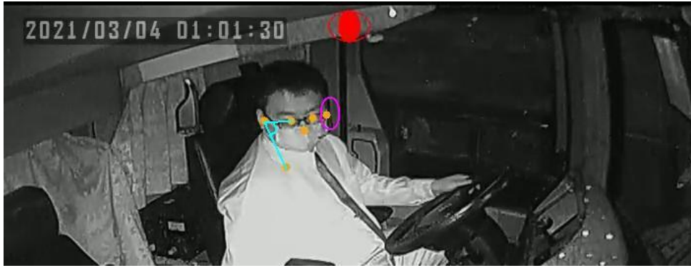
圖 5.1-11 駕駛頭部擺右之關節點推論作法示意
