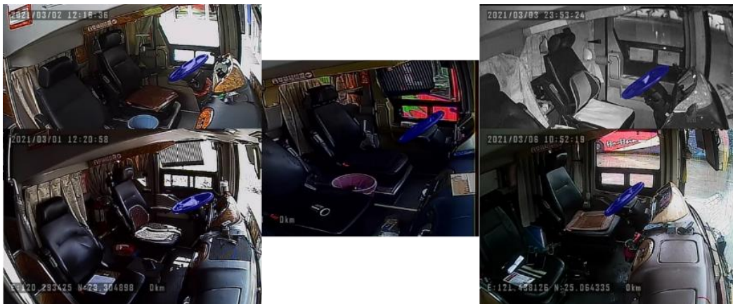
圖 5.1-3 方向盤辨識步驟一：用人工標記方式繪圖 ROI 區域
