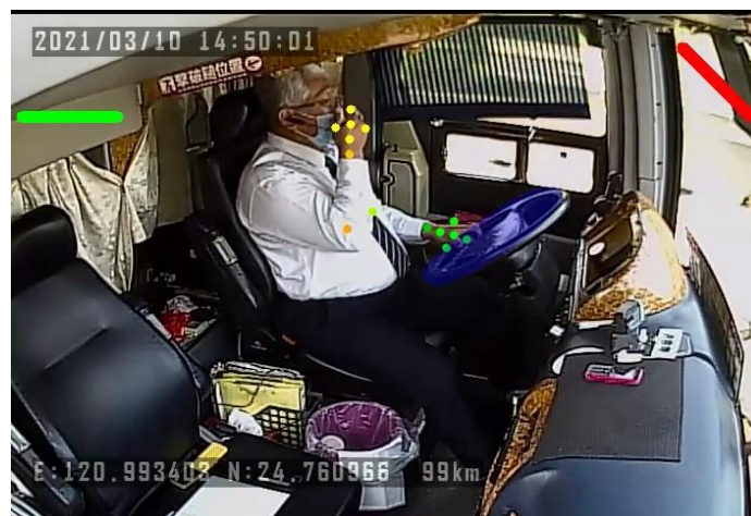
圖 5.1-7 駕駛手部位置推論作法示意
