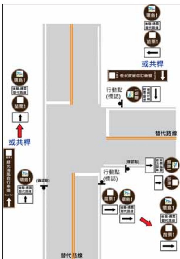
圖 6.3-11 替代路線與地方自行車道共線之轉向路口指引布設範例
