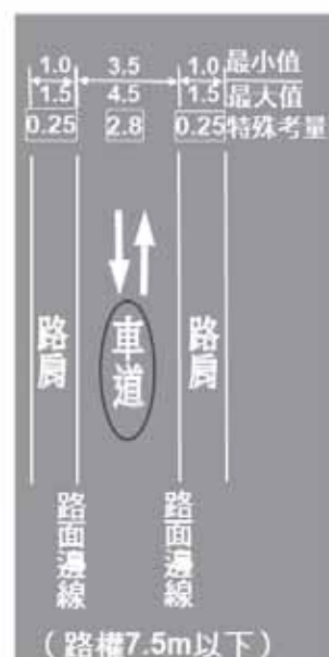
共用最外側車道
