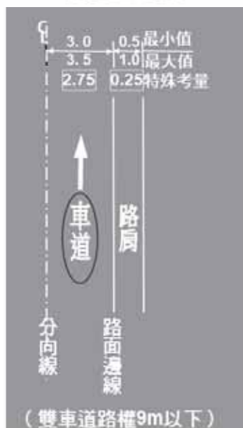
共用最外側車道
