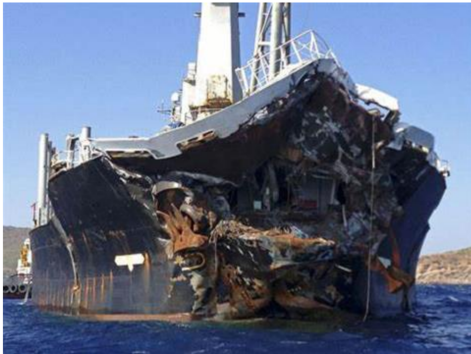
圖 3.8 遊艇因長浪的作用而與碼頭強烈衝撞導致受損(2017/3/4)
