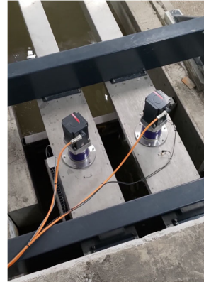
圖 5.1 交通部運輸研究所運輸技術研究中心風洞實驗室 断面水槽尺寸為1.5m寬、2m高及全長約100m，設有2段實驗觀測段，皆為15m長
