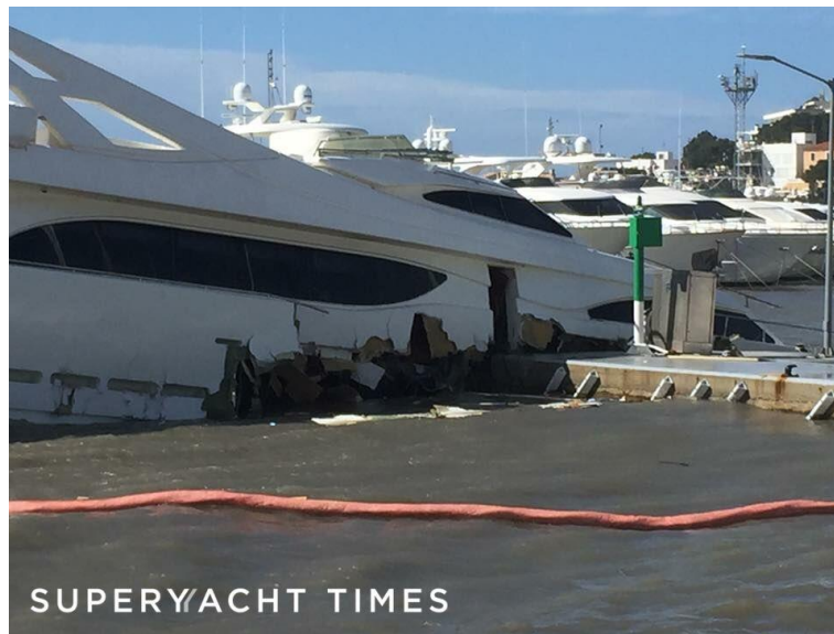
圖 3.8 遊艇因長浪的作用而與碼頭強烈衝撞導致受損(2017/3/4)
