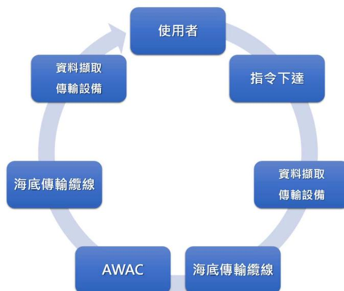
圖4.8 底碇式觀測系統指令暨資料傳輸示意
