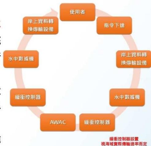
無線式底碇波流觀測系統架構圖
