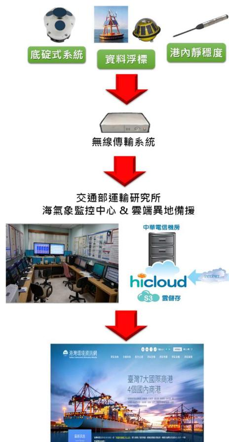
圖 2.1 海象觀測系統傳輸架構圖
