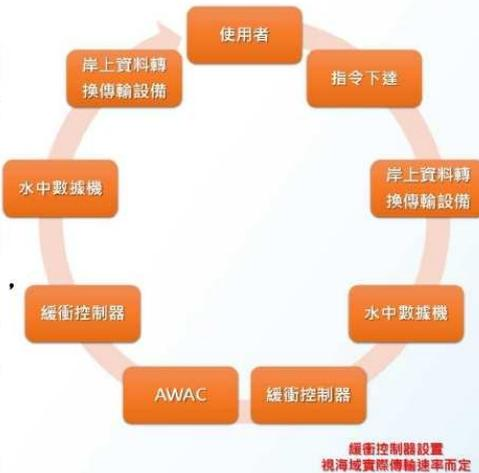
無線式底碛波流觀測系統架構圖
