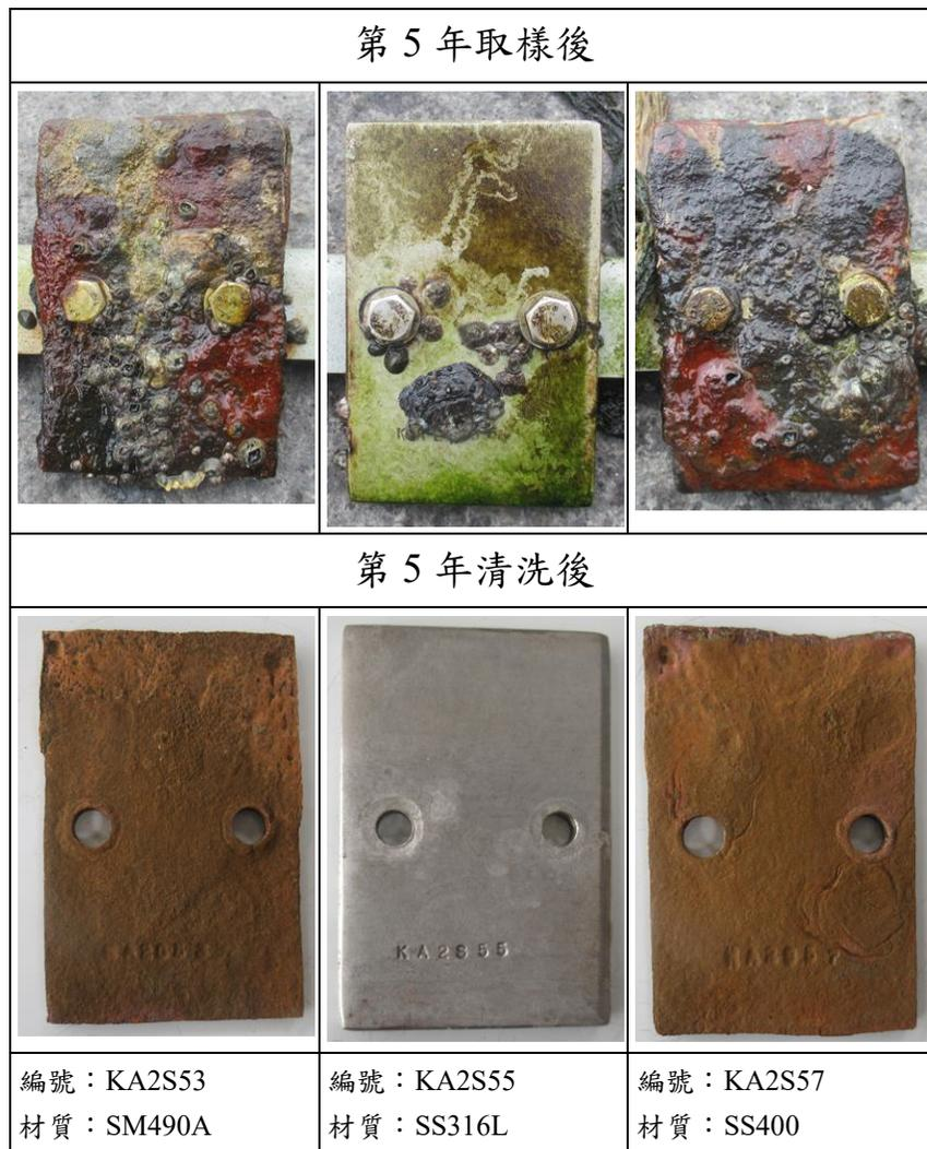
圖 5.44 高雄港 40 號碼頭飛沫帶試片照片
