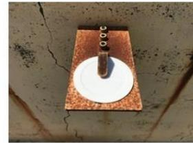
螺旋金屬暴露試驗
