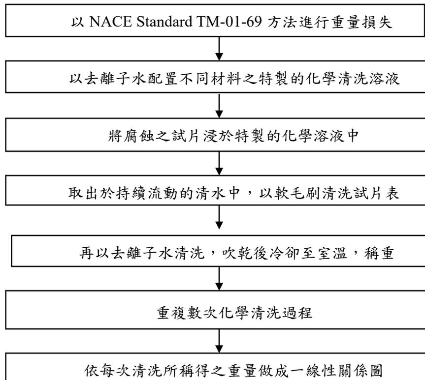
圖 3.12 水下金屬腐蝕生成物清除作業流程圖
