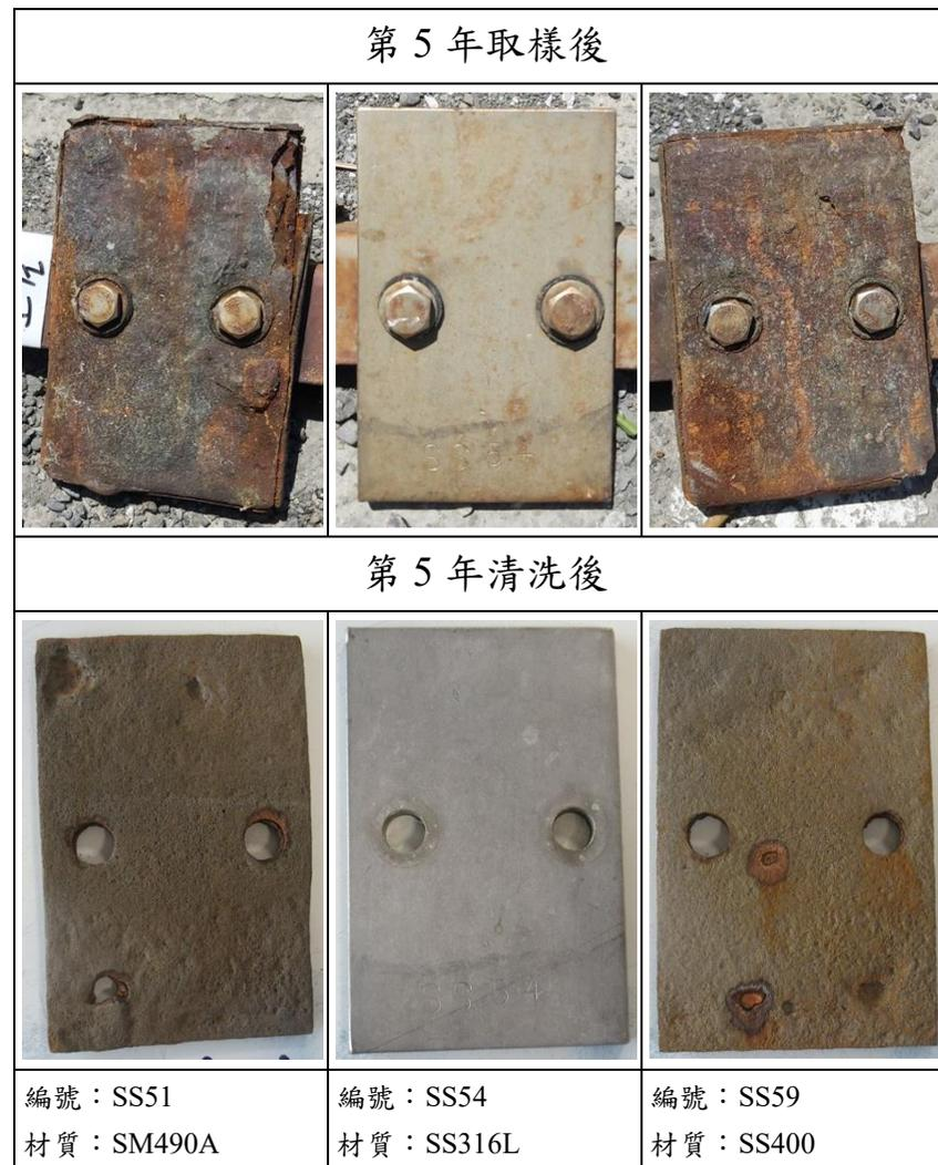
圖 5.27 蘇澳港飛沫帶試片照片
