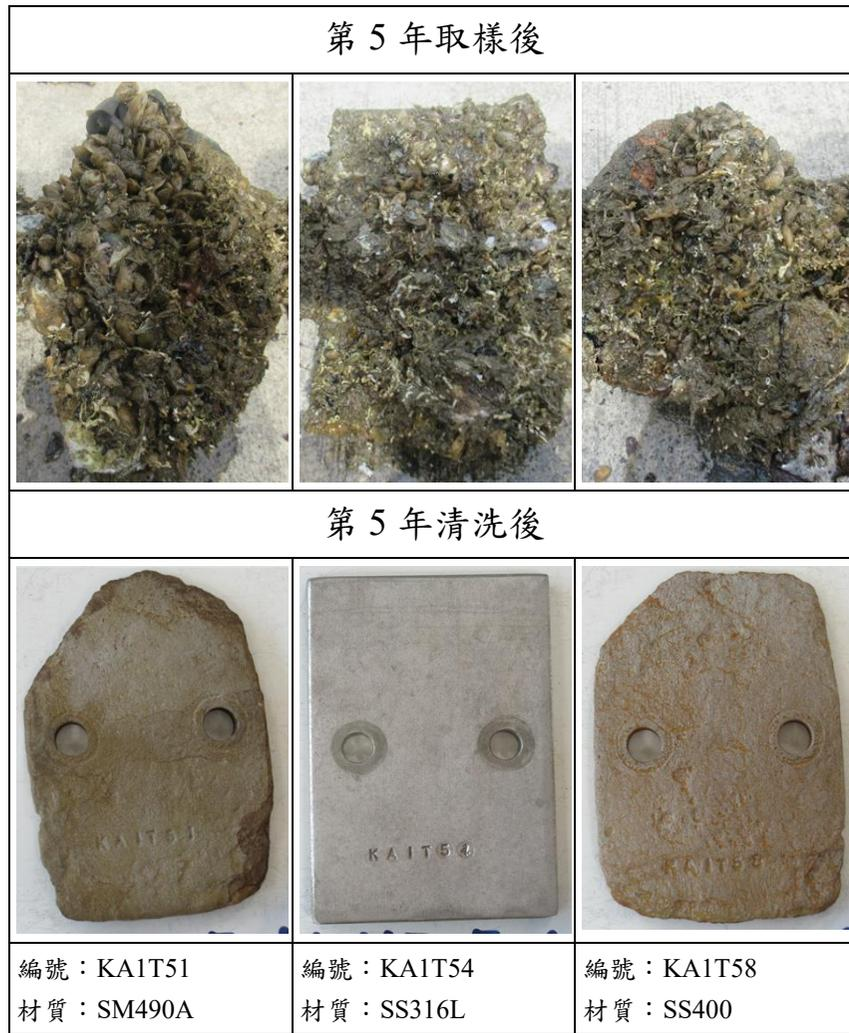
圖 5.42 高雄港 10 號碼頭潮汐帶試片照片
