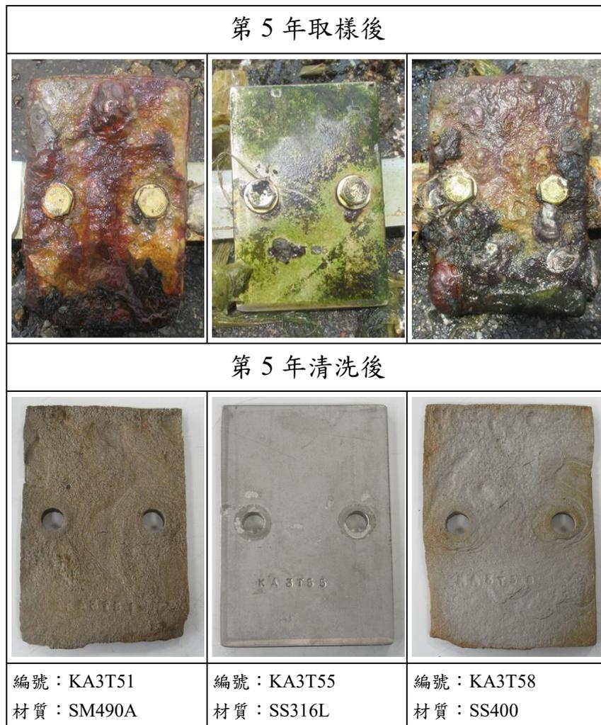
圖 5.46 高雄港 75 號碼頭潮汐帶試片照片
