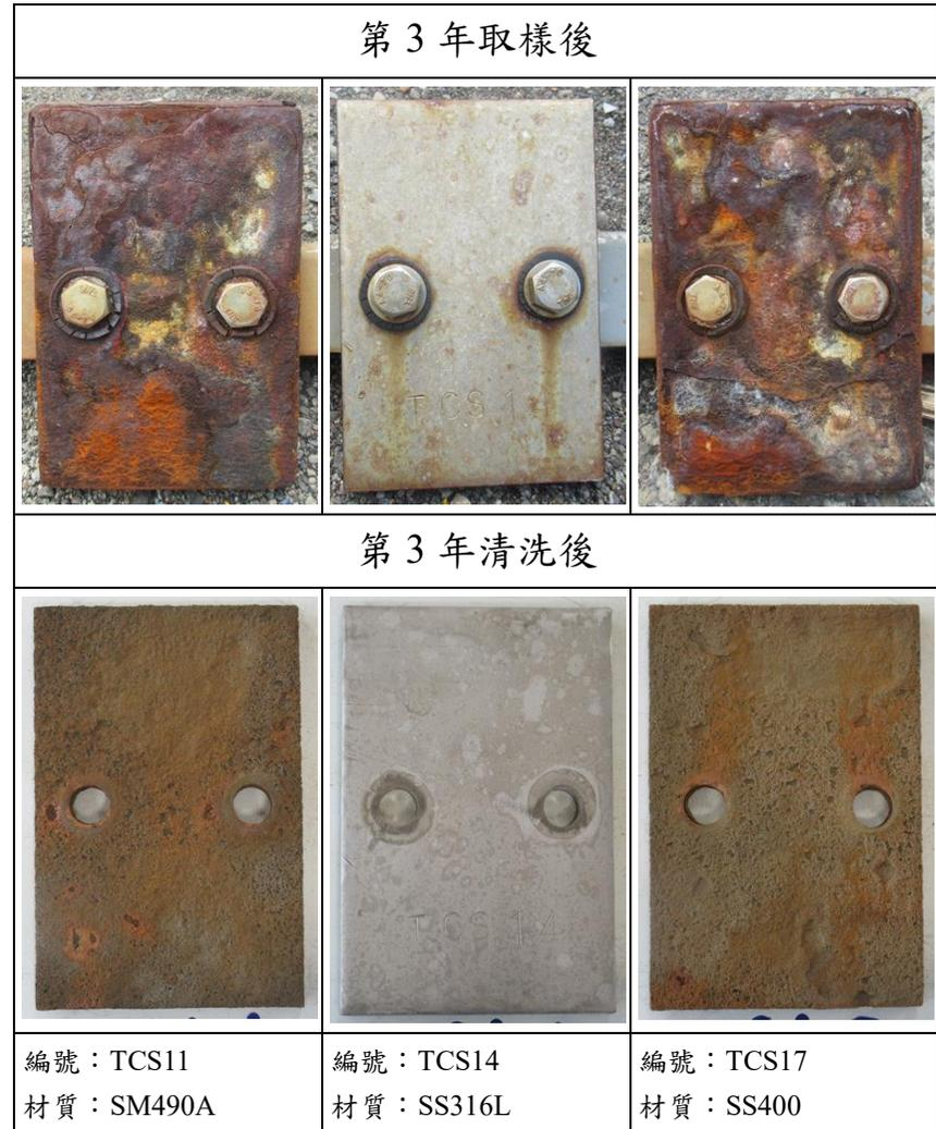
圖 5.33 臺中港飛沫帶試片照片
