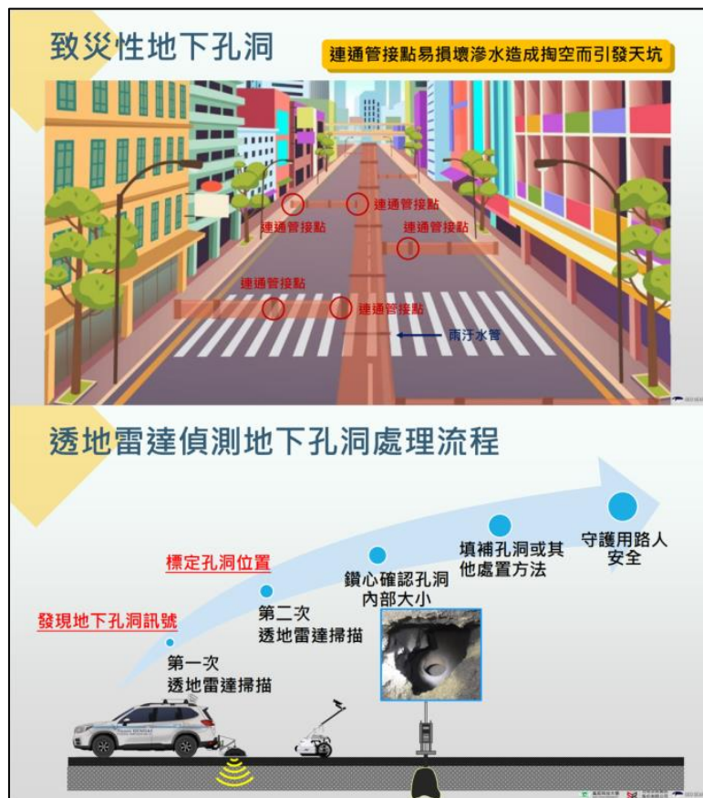
圖 4.6 高雄市政府以透地雷達檢測地下孔洞處理流程(高雄市智慧城市推動平台網站)
