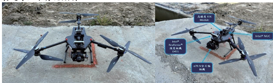
圖 4.42 TD-Y6B-1200 橋梁巡檢無人機各重要零件分布示意圖
