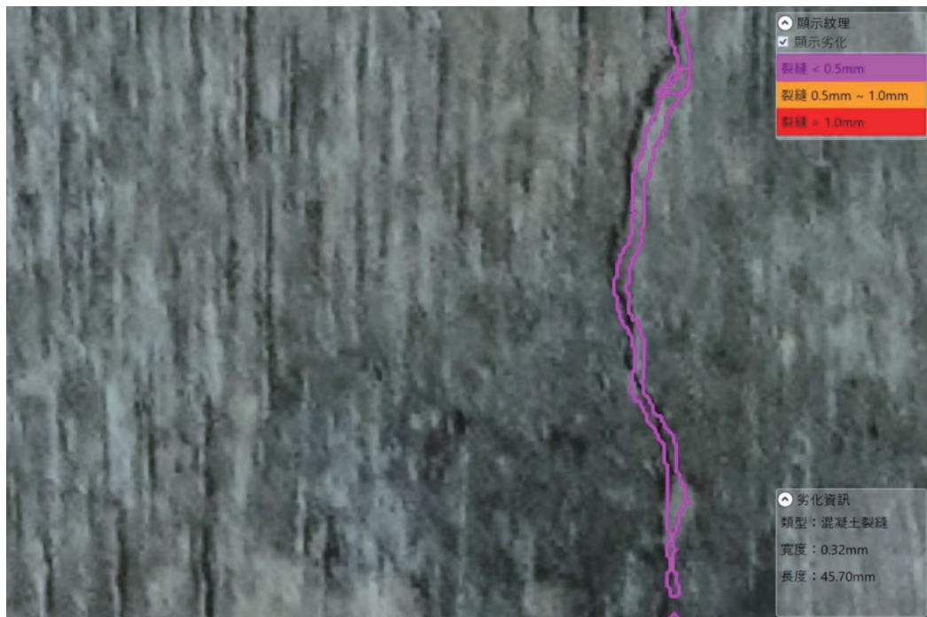
圖 4.131 展示與查詢裂縫寬度與長度
