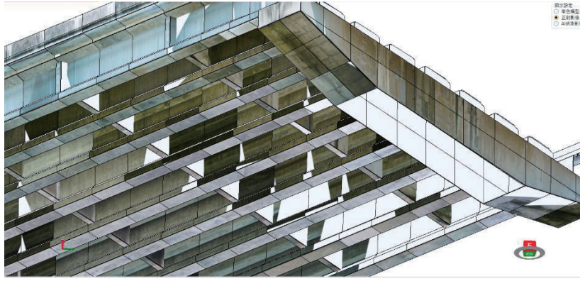
圖 3.29 將正射影像數貼於橋梁 3D 模型之範例
