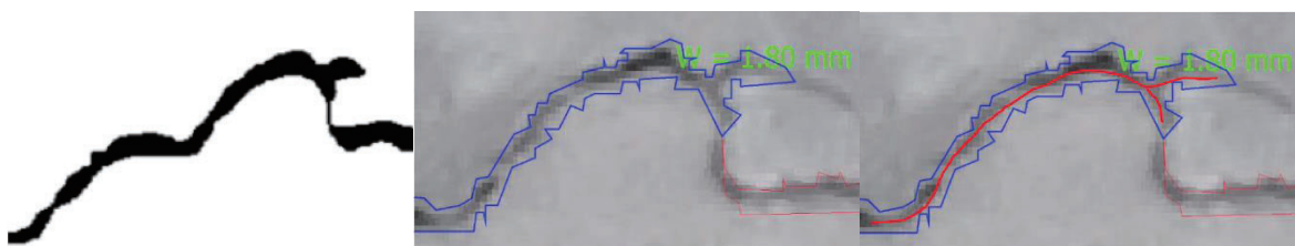
圖 3.4 (左)裂縫影像、(中)裂縫邊緣向量、(右)裂縫骨架向量
