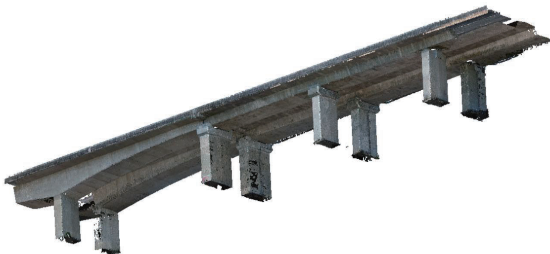
圖 4.40 Autel XT705 無人機拍攝影像所製作之密點雲
