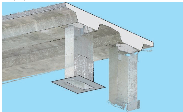
圖 11 建立參考面並使用推拉工具長出橋墩特徵
