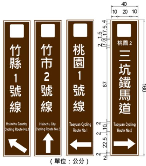
圖 2.1-6 直立式自行車環島路線指示標誌牌面
