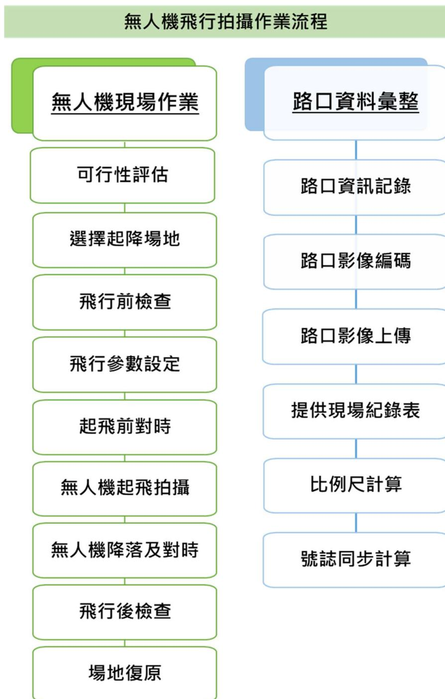
圖 3.1-5 無人機實地空拍作業流程
