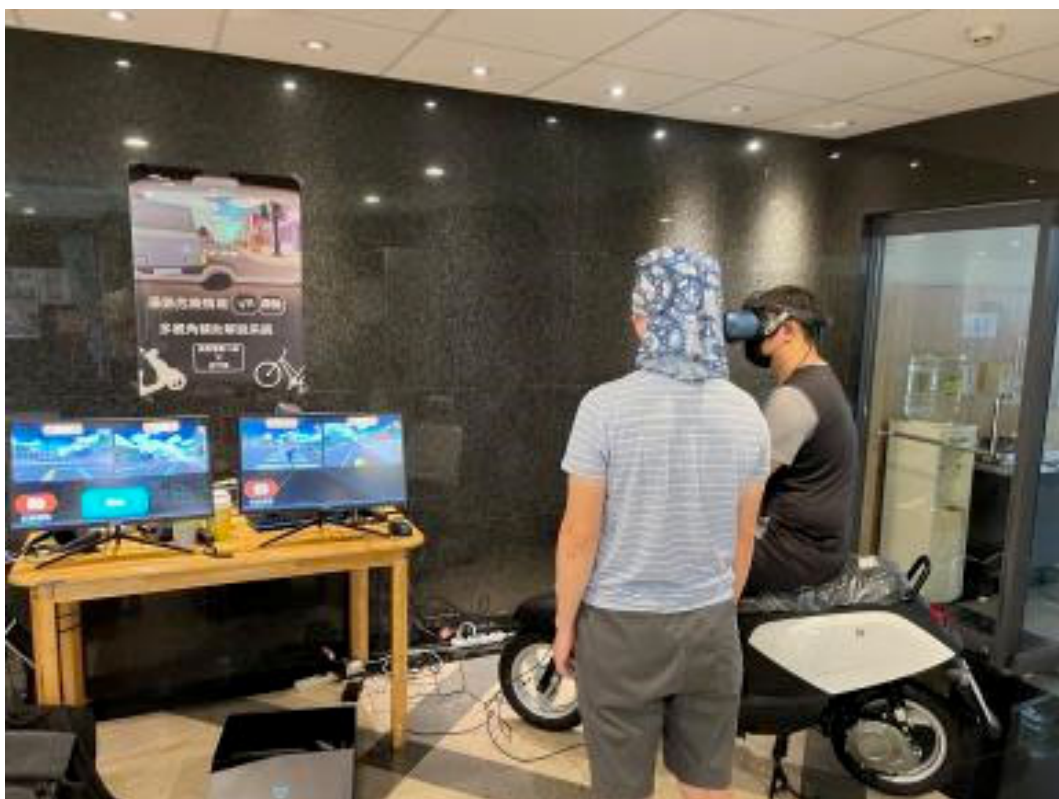
圖 86、完成油門、煞車以及方向燈訊號改裝之微型電動二輪車
