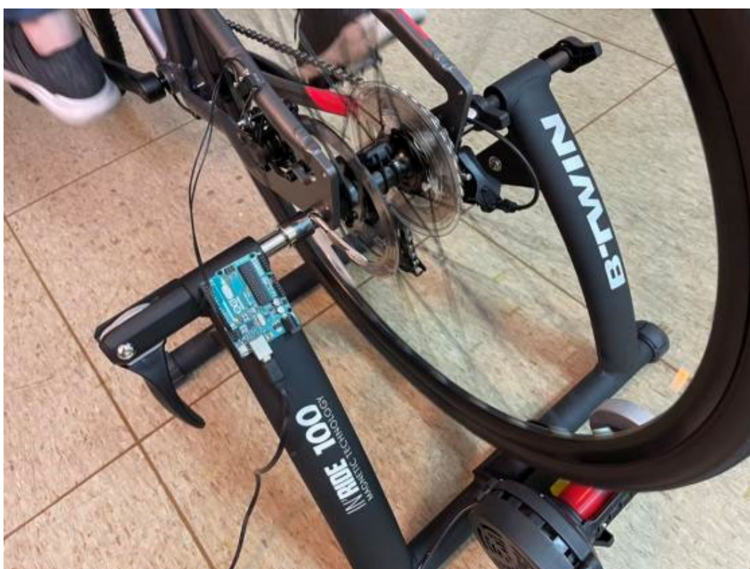
圖 87、完成煞車訊號擷取改裝之自行車
