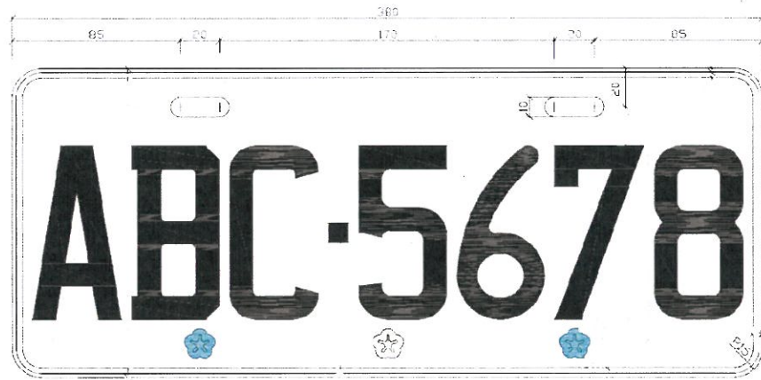
汽車號牌(長 380mm 高 160mm)螺絲鎖孔位置圖
