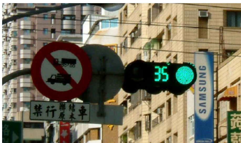
圖 1-4 內建式綠燈倒數計時顯示裝置設置圖
