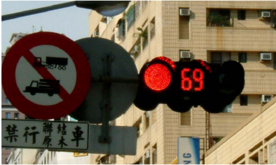
圖 1-5 內建式紅燈倒數計時顯示裝置設置圖
