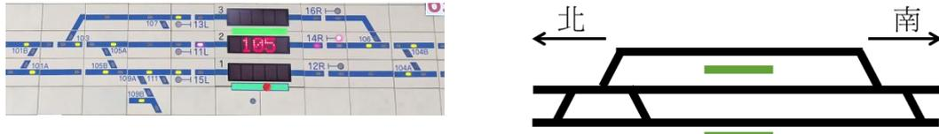
圖 6.2 臺鐵臺南站（地下化前）行控中心面板照片與軌道模型對照圖
