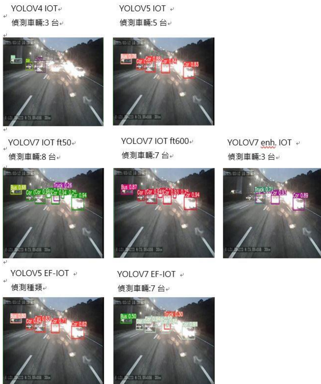
圖 6.1-13 強光影像過曝水珠或地面反光特徵細節模糊偵測效果比較
