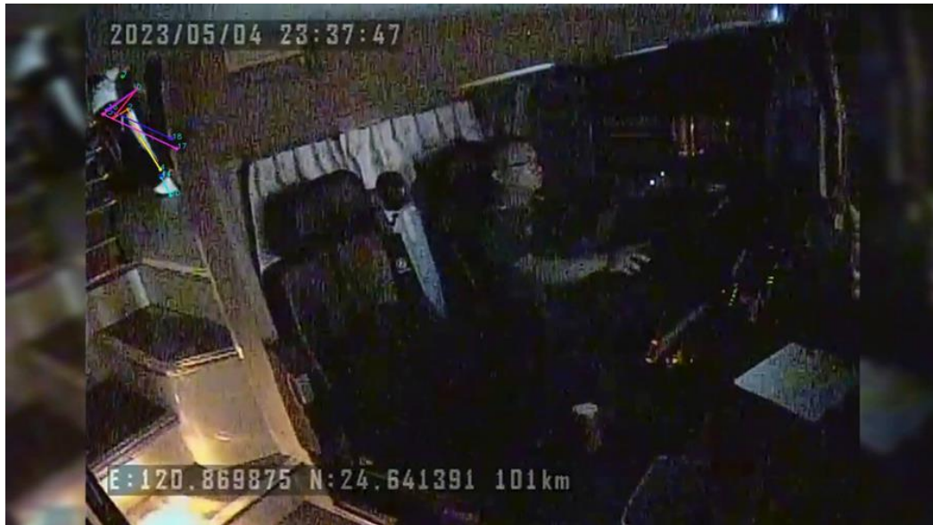
圖 6.2-19 車內 IR 或是濾光片自動切換功能沒有正確開啟的車輛成像
