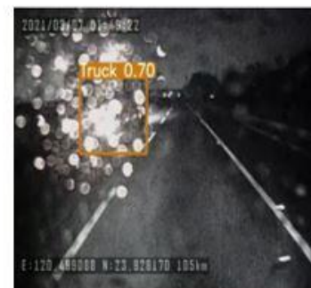
圖 6.1-8 低光照影像過暗和雜訊水珠或地面反光偵測效果比較
