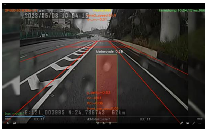
圖 6.1-21 擋風玻璃雨滴附著出現偵測機車的異常
