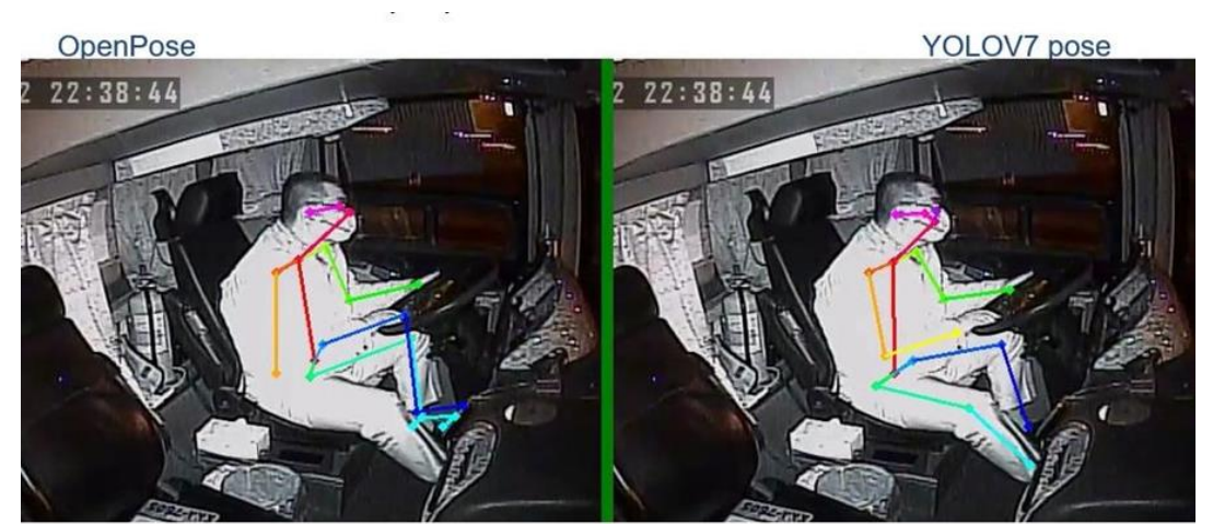
圖 6.2-8 駕駛關節點偵測在夜間 IR 狀態下的改善
