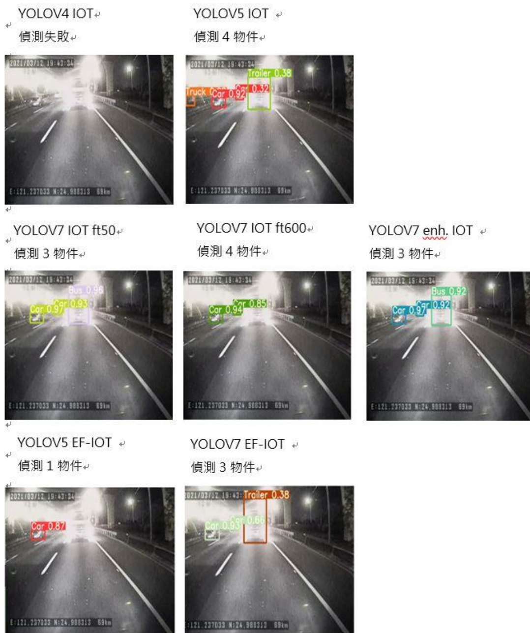
圖 6.1-6 強光影像過曝和雜訊，特徵細節丟失偵測效果比較
