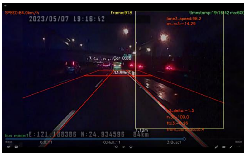
圖 6.1-23 地面反光出現偵測大客車的異常
