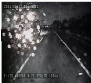
圖 6.1-8 低光照影像過暗和雜訊水珠或地面反光偵測效果比較
