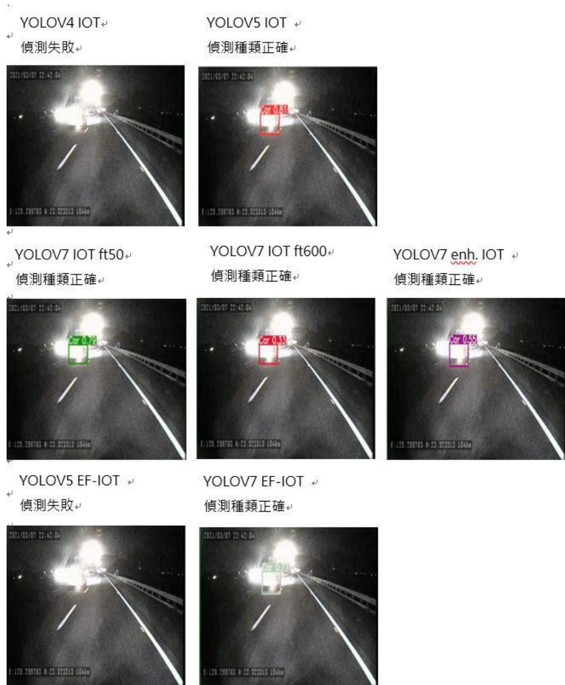
圖 6.1-10 低光照影像過曝和雜訊輪廓和特徵細節丟失偵測效果比較
