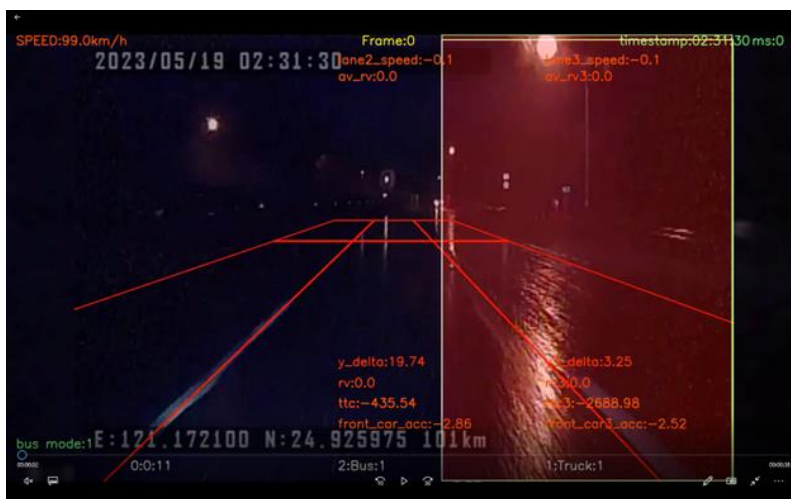
圖 6.1-24 地面反光出現偵測卡車的異常
