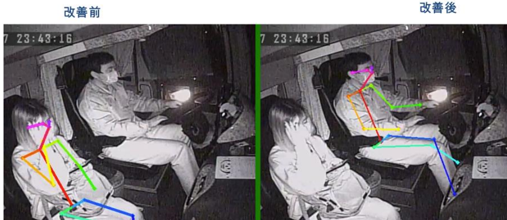
圖 6.2-2 車內模型偵測時遇到多物件狀況目標選擇方法改善
