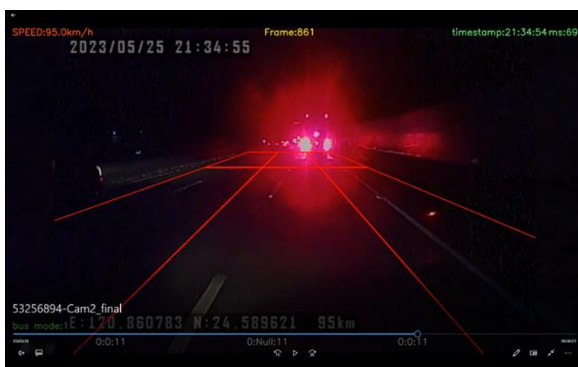
圖 6.1-18 夜間部分影片出現煞車燈的炫光現象
