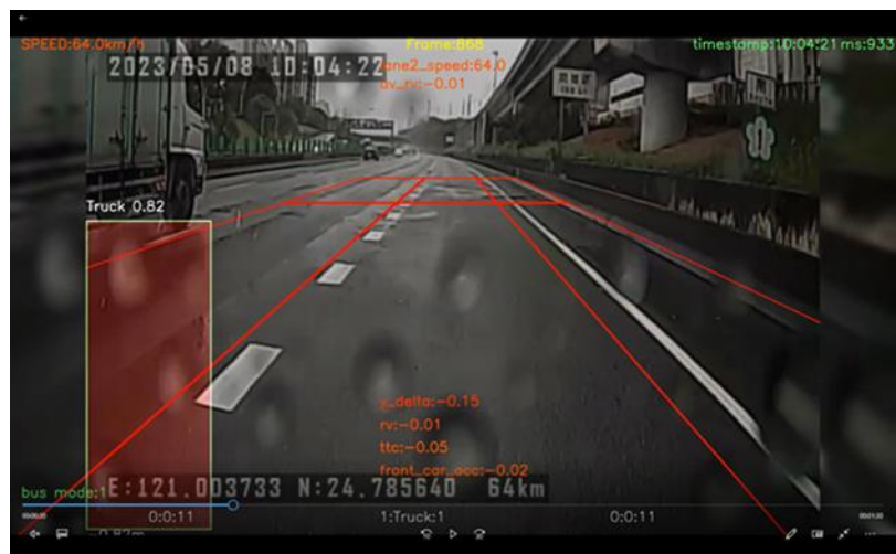
圖 6.1-22 擋風玻璃雨滴附著出現偵測卡車的異常
