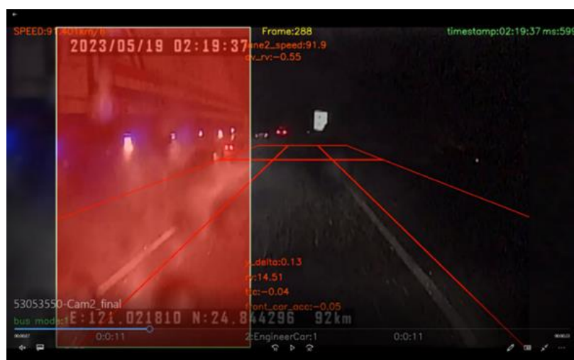
圖 6.1-19 豪雨狀況物件偵測拖車出現 bounding box 範圍過大的異常
