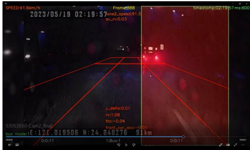
圖 6.1-20 豪雨狀況偵測大客車出現 bounding box 範圍過大的異常
