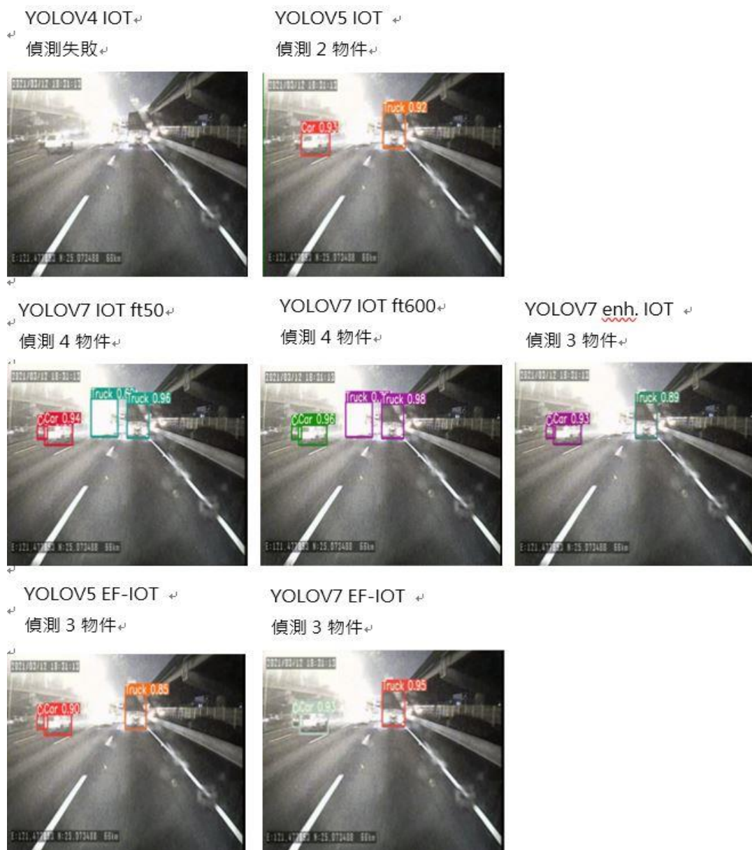
圖 6.1-7 強光影像過曝水珠或地面反光特徵細節模糊偵測效果比較
