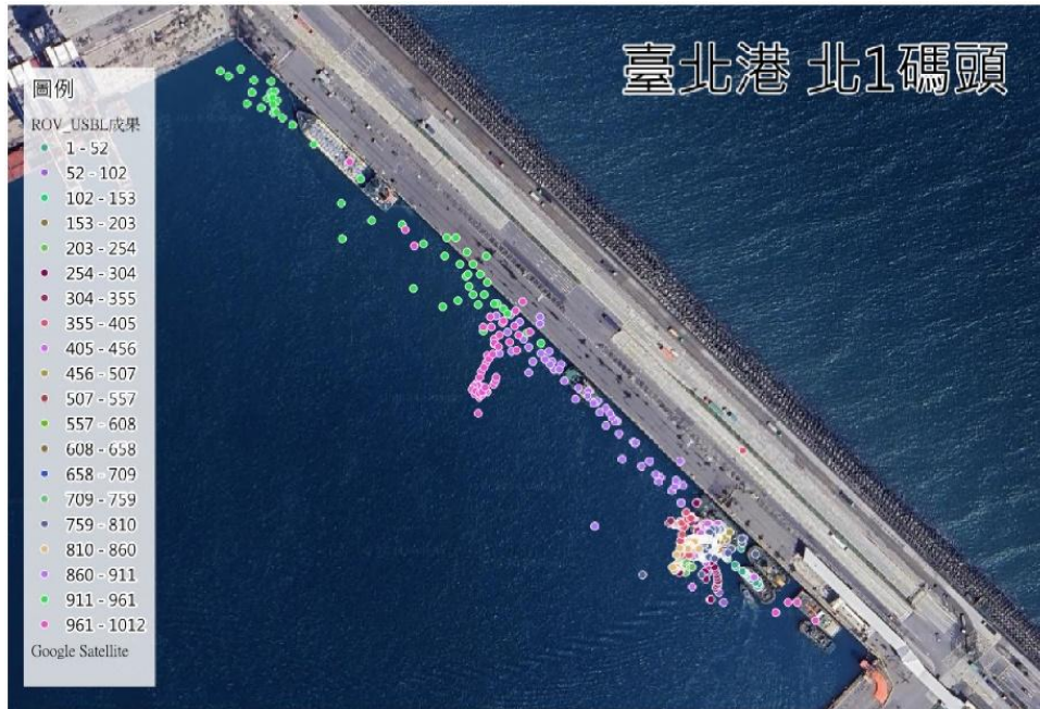
圖 7 USBL 定位成果展繪並套疊通用版正射影像
