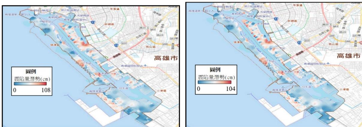
圖 10 設計地震下高雄港區震陷潛勢圖(左：HBF 法；右：NCEER 法)
