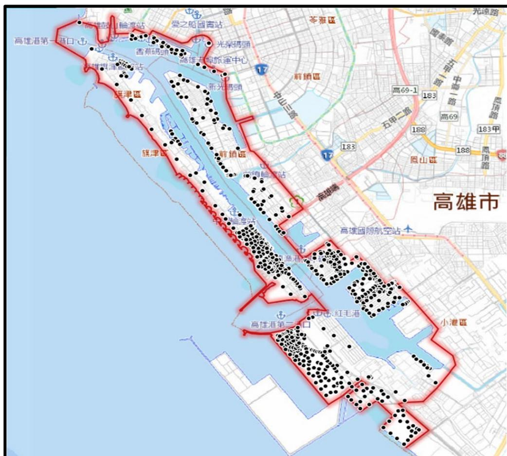
圖 4 高雄港區可用 SPT 鑽探孔位分布情況(本研究繪製)
