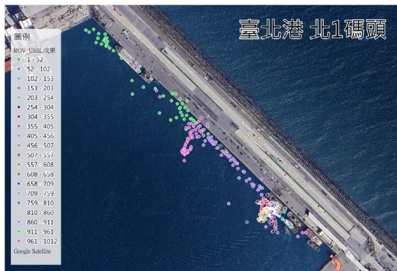
圖 12 USBL 定位成果展繪並套疊通用版正射影像
