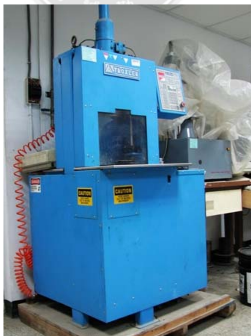
圖 3.24 SGC 旋轉式試驗儀
