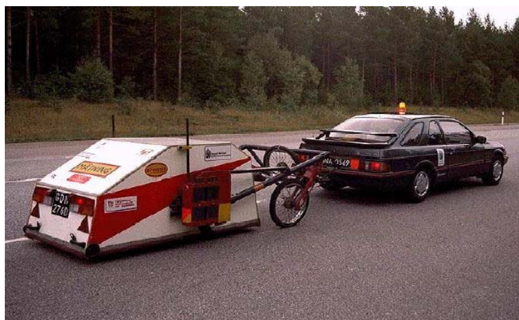
圖 2.4 CPX 法蓬罩式拖車配置【34】
