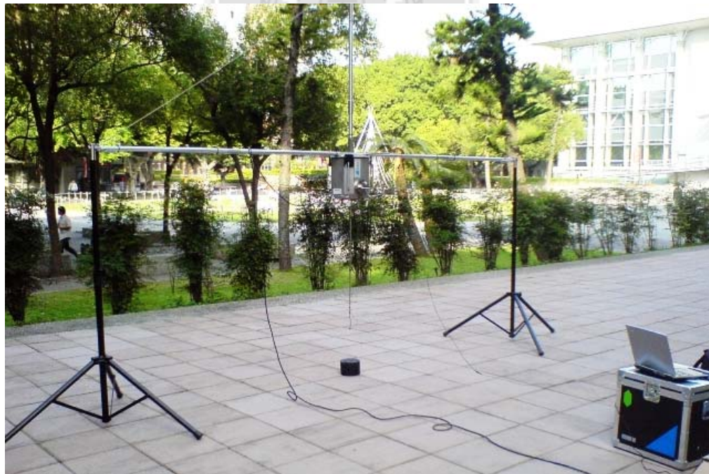
圖 3.15 吸音率測量現場配置圖
