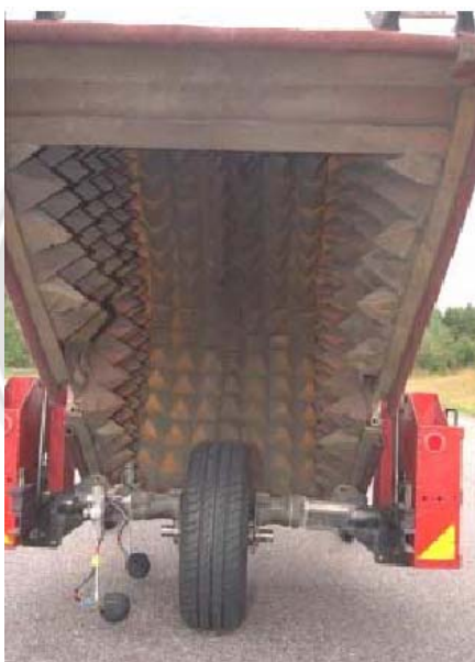
圖 2.5 CPX 法蓬罩式拖車內部配置實例【34】
