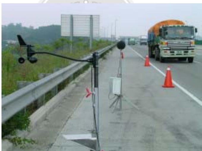
圖 3.4 噪音計與氣象儀架設位置
