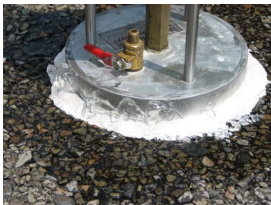
圖 3.7 水由儀器與鋪面間縫隙流出
