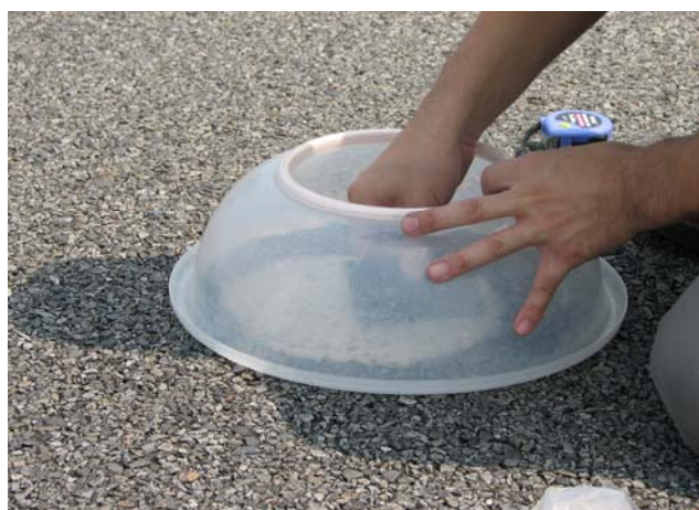
圖 3.8 使用屏風避免標準砂被吹開
