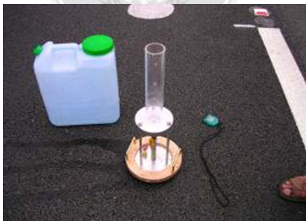
圖 3.5 透水量試驗所需器材
