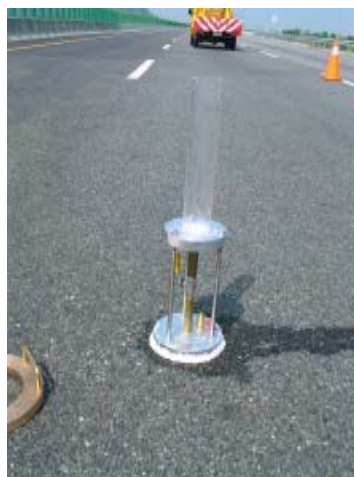
圖 3.6 透水量測點試驗後之情形
