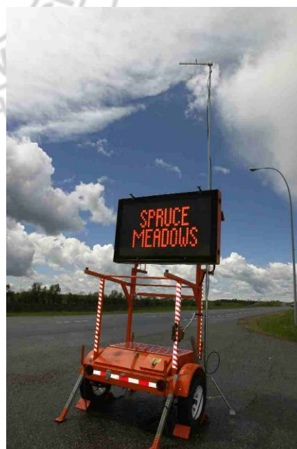
圖 2.2-7 WiTec Alberta 無線資訊可變標誌制系統
