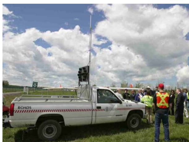
圖 2.2-7 WiTec Alberta 無線資訊可變標誌制系統
