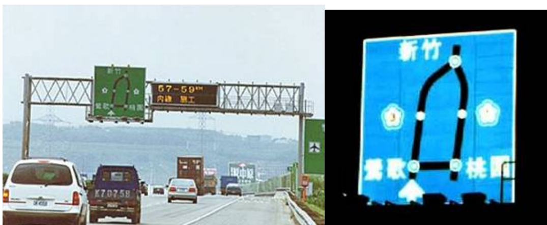
圖 2.2 圖誌可變標誌（安裝於系統交流道前）
