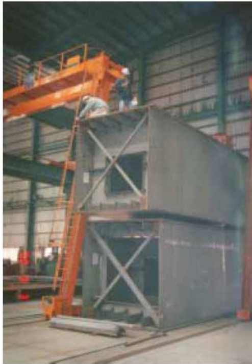
圖 4.3 典型之橫向剛架式內橫隔梁系統
