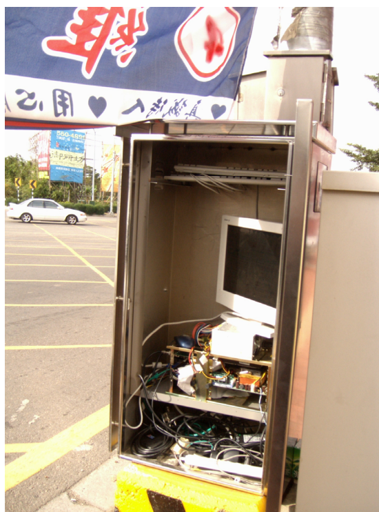
圖 9-5 影像式偵測器控制器內部裝置圖
