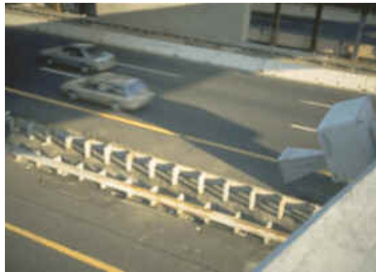
圖 4.9 側射式微波雷達車輛偵測器示意圖
