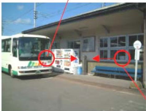
(A)車載天線及 DSRC 設備
